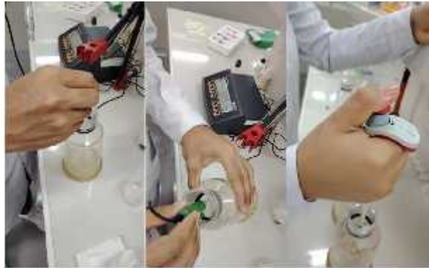
Ajustamos pH y agregamos amilogrucasidasa
