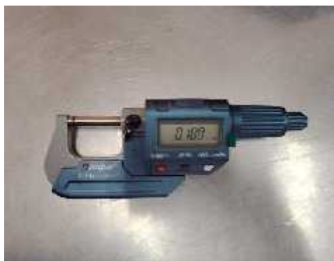
Micrómetro digital para medir espesor
