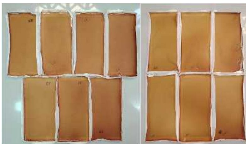
Bioplástico de almidón de semilla de palta y harina de residuos de café
