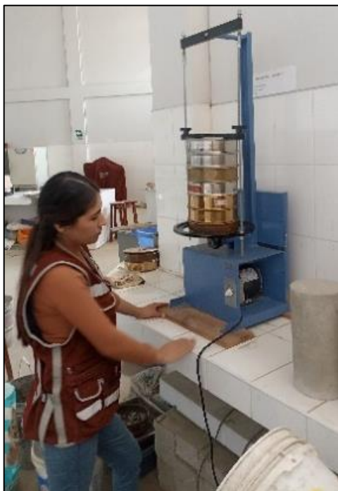
Foto n° 14 Ejecución del ensayo de granulometría, utilizando el agitador mecánico.
