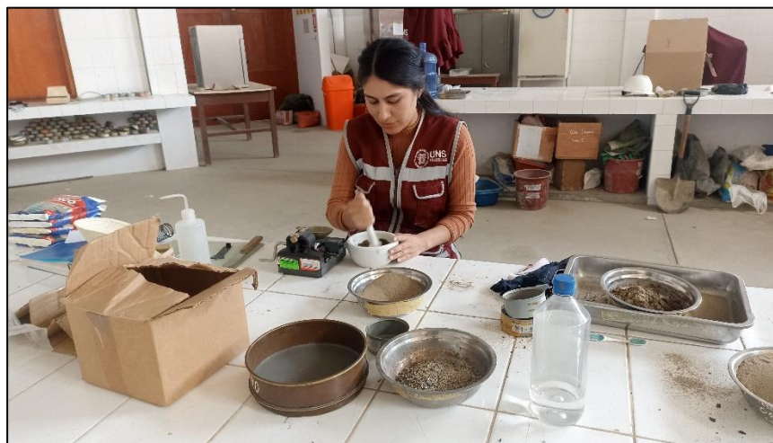
Foto n° 15 Ejecución del ensayo de limites líquido y plástico, en el laboratorio de Mecánica de Suelos.
