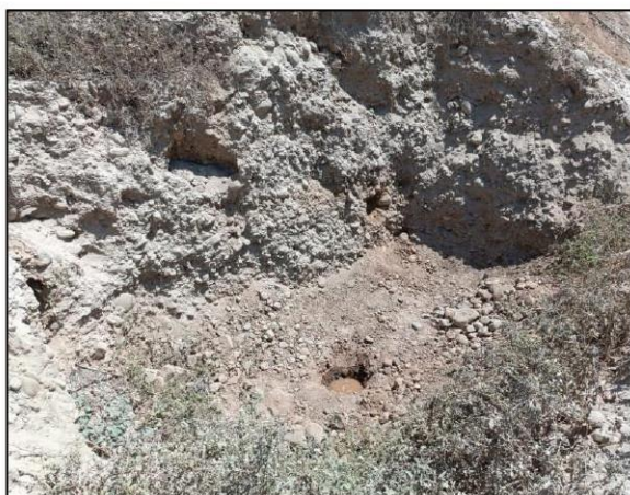
FOTO 01: SE OBSERVA LA EXCAVACIÓN CALICATA C-01.
