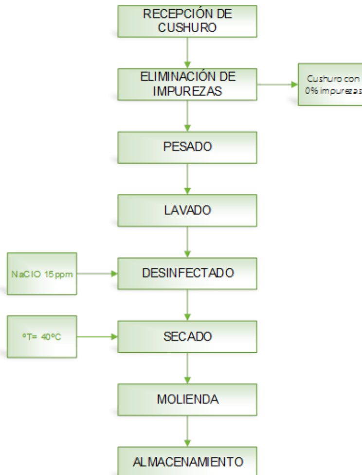
Ilustración 7: Diagrama de bloques para la elaboración de harina de cushuro ( Nostoc sphaericum )
