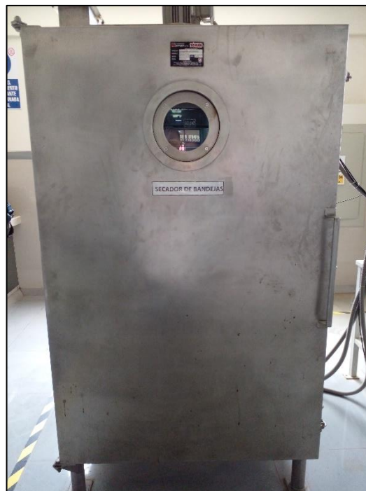
Secado en el secador de bandejas (THORR, modelo: sbt-10xl). Temperatura de 50 °C durante 24 h
