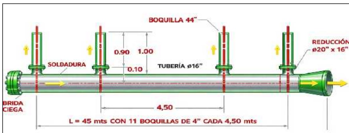
Figura 14: Esquema de distribución de toberas en difusores de Emisario APROFERROL
