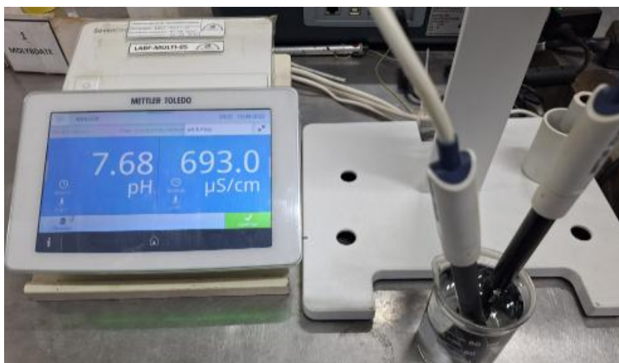
Ilustración 13 Determinación de la conductividad y pH de la muestra del centro poblado de San Jacinto.
