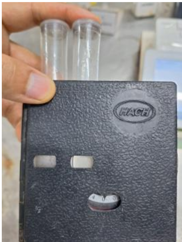
Ilustración 20 Muestra analizada con el kit para determinar cloro libre residual del centro poblado de Huacatambo.
