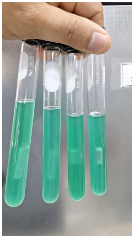
Ilustración 27 Muestras positivas confirmativas para coliformes totales. (Formación de burbujas y turbidez)
