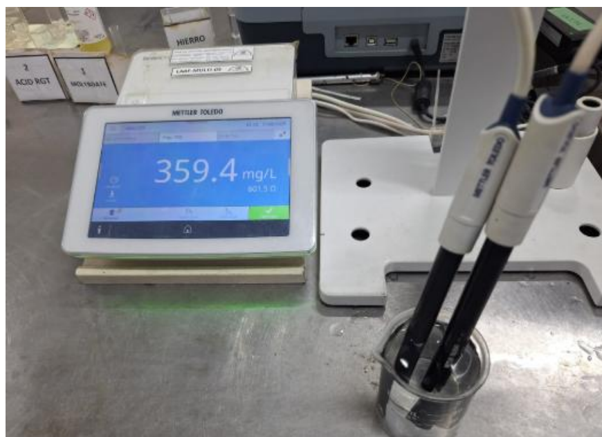
Ilustración 15 Determinación de sólidos totales disueltos de la muestra del centro poblado de Huacatambo.
