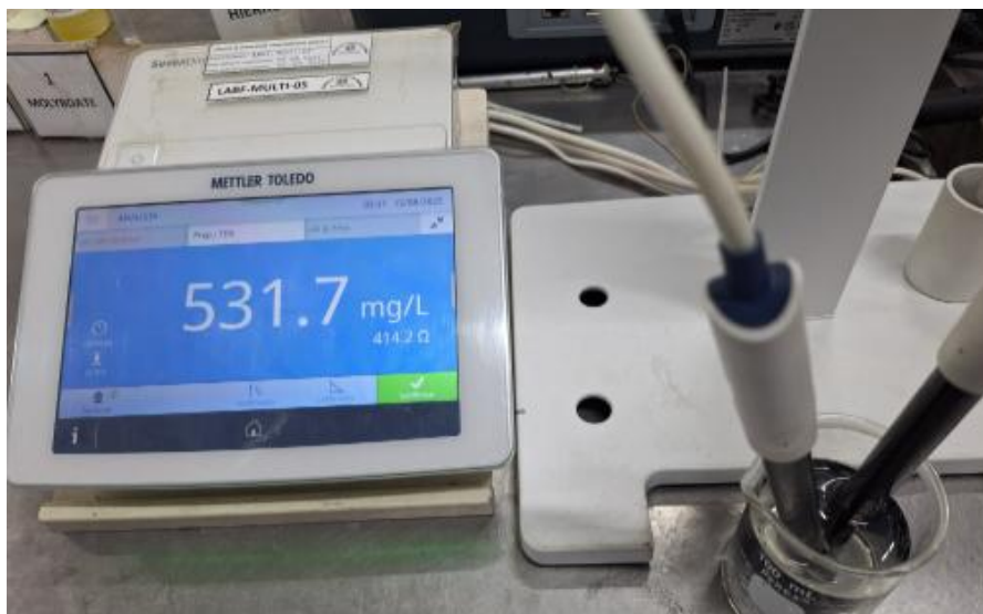
Ilustración 14 Determinación de sólidos totales disueltos de la muestra del centro poblado de San Jacinto.
