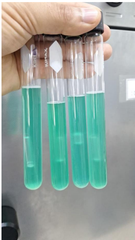
Ilustración 27 Muestras positivas confirmativas para coliformes totales. (Formación de burbujas y turbidez)
