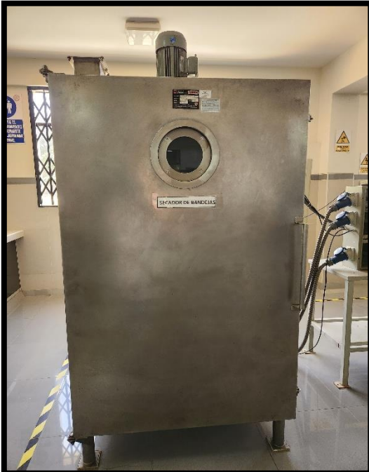
Secado del snack extruido a una temperatura de 50°C en un lapso de 12 horas.
