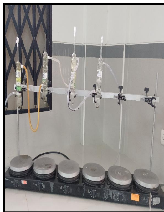
Colocación de los dedales del equipo.
