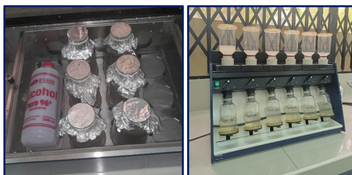
Anexo 8.4. a Transferencia de precipitado y suspensión; b Lavado de residuos
