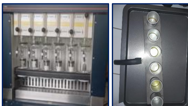
Anexo 6.4. a Operación de extracción con el equipo Soxhlet; b Vasos colectores después de la extracción
