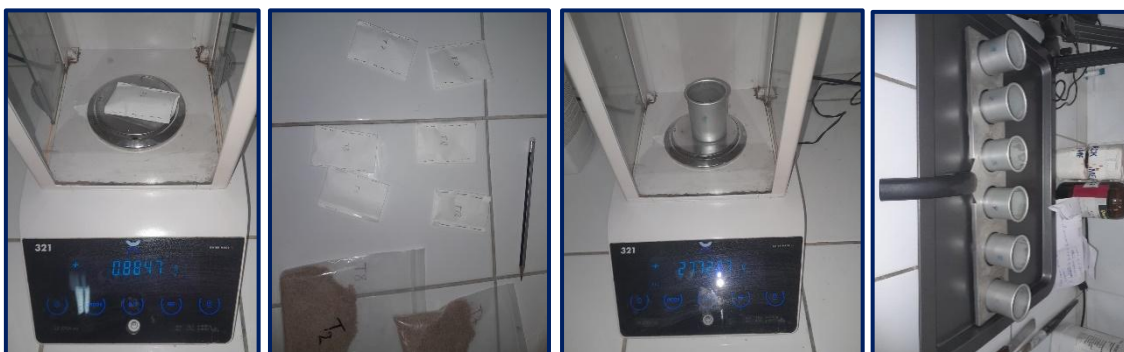
Anexo 6.4. a Operación de extracción con el equipo Soxhlet; b Vasos colectores después de la extracción
