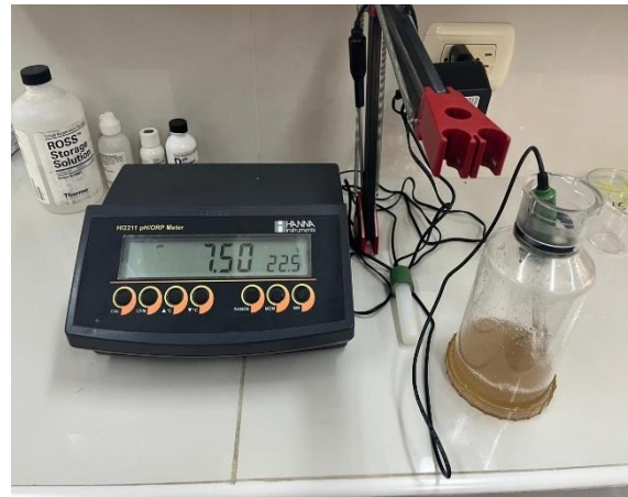
Anexo 46 Ajuste de pH 7.5 con NaOH
