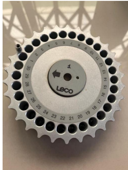
Anexo 38 Colocación de muestras en el equipo DUMAS
