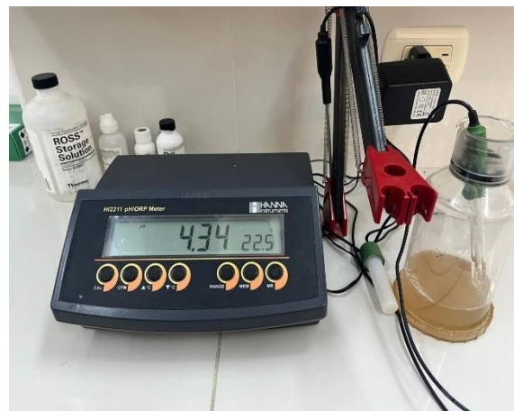
Anexo 48 Ajuste de pH 4-4.6 con HCl
