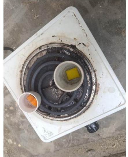
Figura 47 Calentado de muestras hasta obtener sus cenizas
