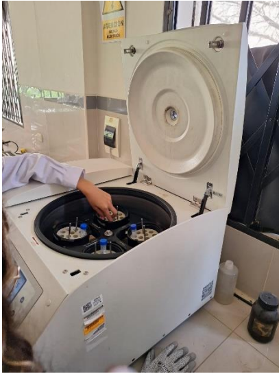
Figura 79 Centrifugado a 4000 RPM
