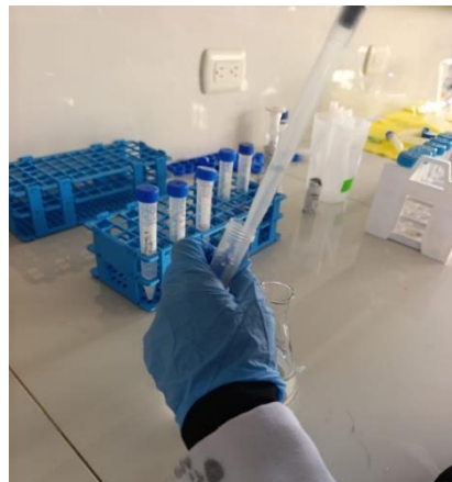
Figura 78 Agregado 5 ml de solución agua/metanol
