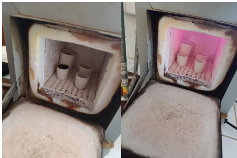
Figura 48 Colocado de los crisoles en la mufla
