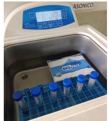
Figura 79 Baño ultrasónico por 30 minutos
