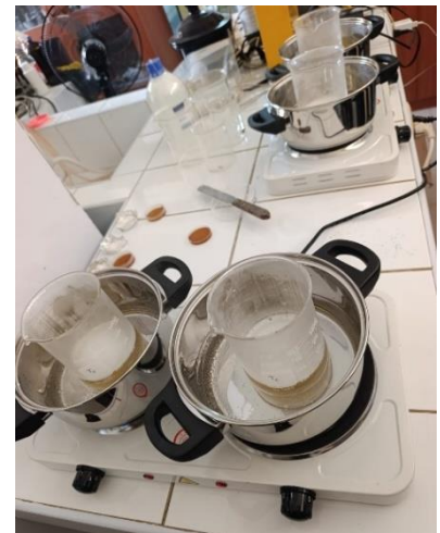
Figura 54 Tratamientos de recubrimiento comestible en baño María
