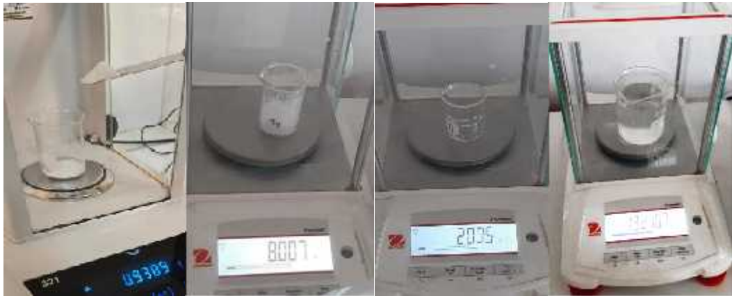
Figura 25. Pesado de los materiales adecuados para la elaboración de Películas Biodegradables (almidón de oca, gel de aloe vera, glicerol y Agua Destilada respectivamente)
