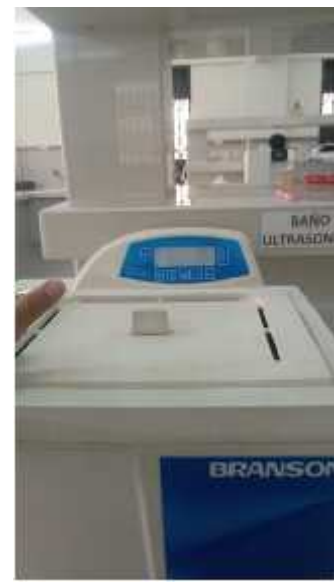
Figura 28. Entrada a Ultrasonido para eliminación de burbujas originadas tras la Mezcla.
