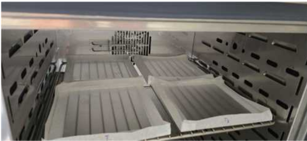
Figura 30. Entrada de Moldes junto a Mezcla a la Estufa para ser secadas a 40°C o 45°C según el tratamiento indicado.
