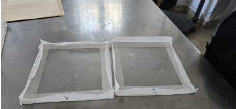
Figura 29. Vertido de Mezcla en Moldes adaptados para entrada a Estufa.
