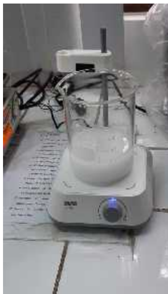
Figura 26. Mezclado de Agua destilada, almidón, gel y glicerol en Agitador Magnético.
