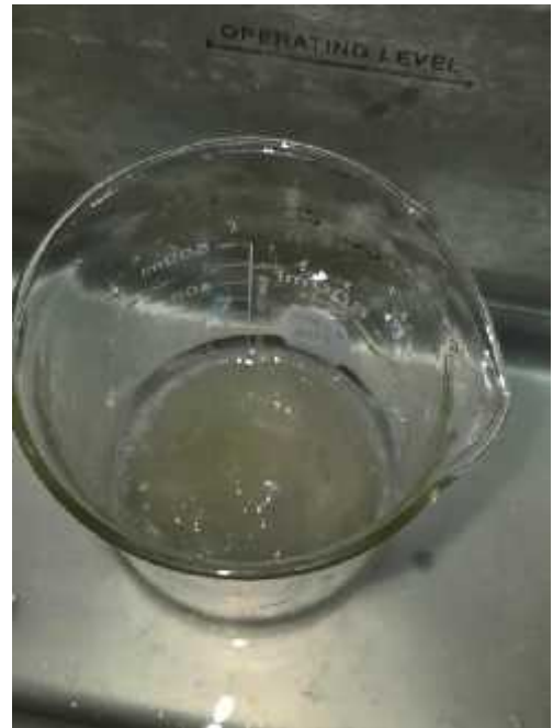
Figura 23. gel de aloe vera en ultrasonido para eliminación de burbujas.
