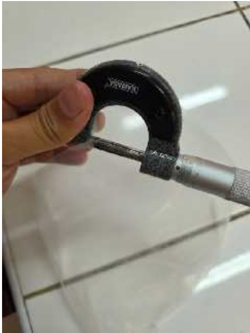
Figura 32. Micrómetro empelado para la Prueba de Películas Biodegradables
