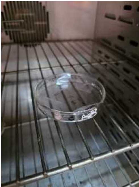
Figura 36. Secado de Películas Biodegradables a 70°C en estufa
