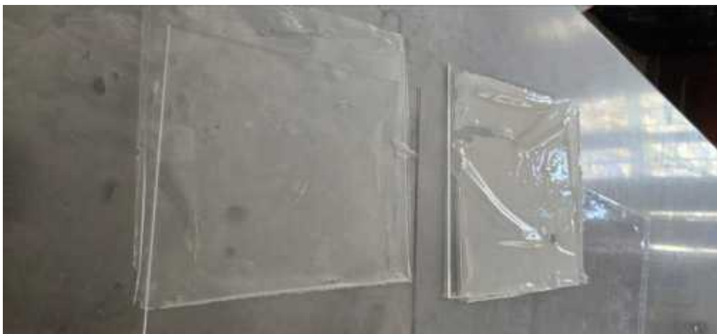
Figura 31. Películas biodegradables obtenidas de almidón de oca ( Oxalis tuberosa ) y gel de aloe vera ( Aloe barbadensis Miller)
