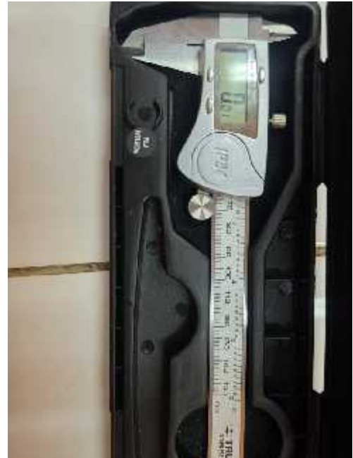
Figura 34. Vernier Digital empelado para la Prueba de Películas Biodegradables
