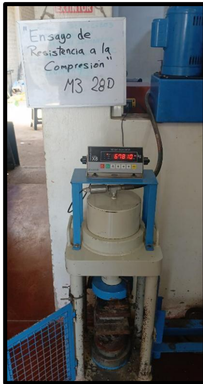
Ensayo de resistencia a la compresión
