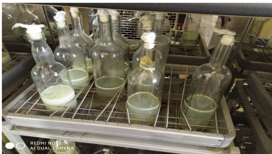
Figura 40: Agregado de scraps e incubación en el shaker 30° C
