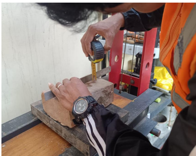
Foto 2: Determinación del alabeo en unidad de albañilería de arcilla.
