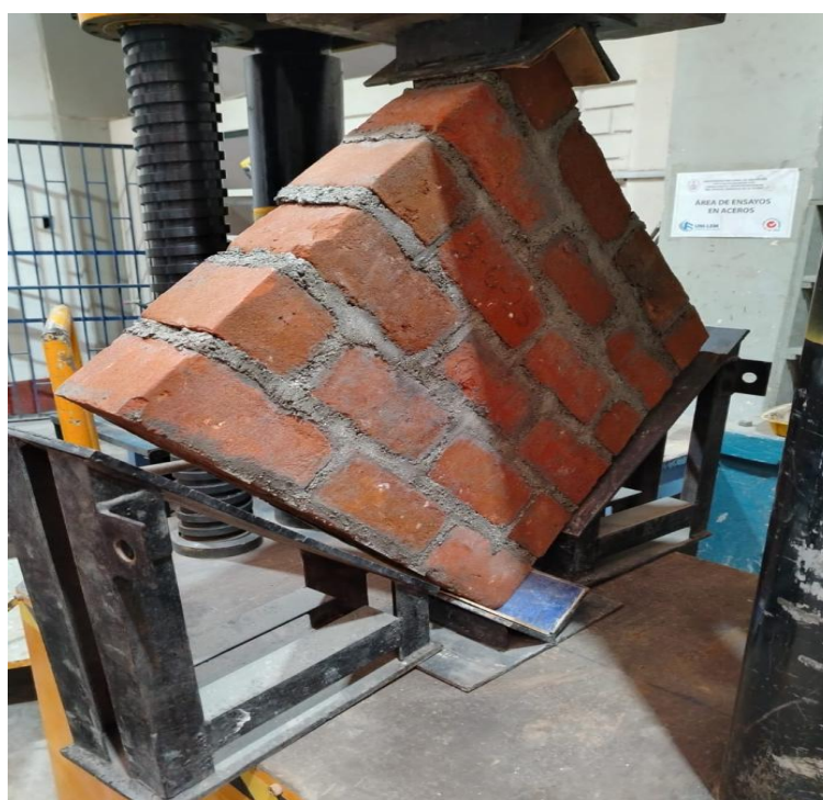
Foto 8: Ensayo de compresión de diagonal de muretes en muro de albañilería con ladrillos de arcilla bajo prensa hidráulica.
