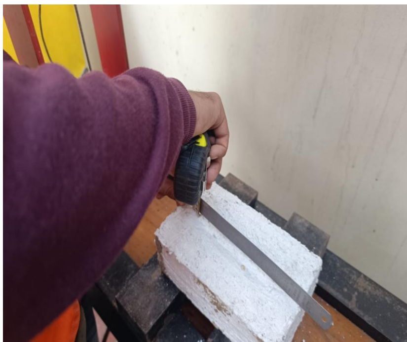
Foto 1: Medición del alabeo en ladrillos silico calcáreos.
