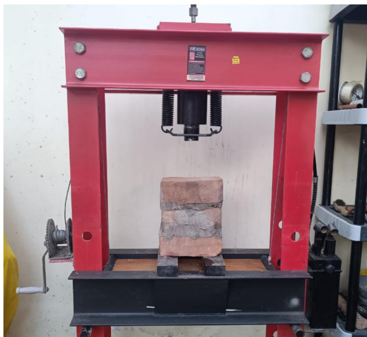
Foto 6: Ensayo de compresión en pilas de unidades de albañilería de arcilla.
