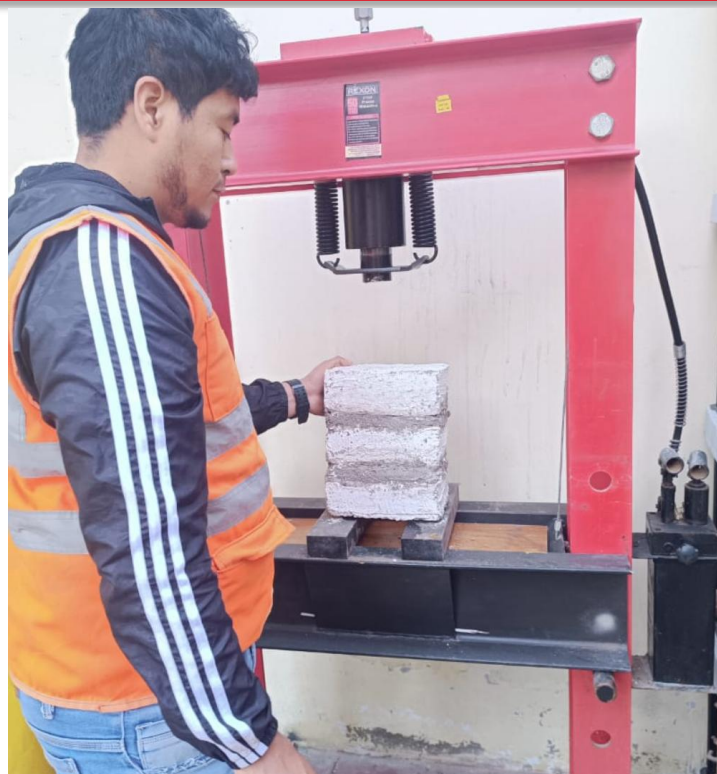
Foto 5: Ensayo de compresión en pilas de unidades de albañilería silico-calcáreo.
