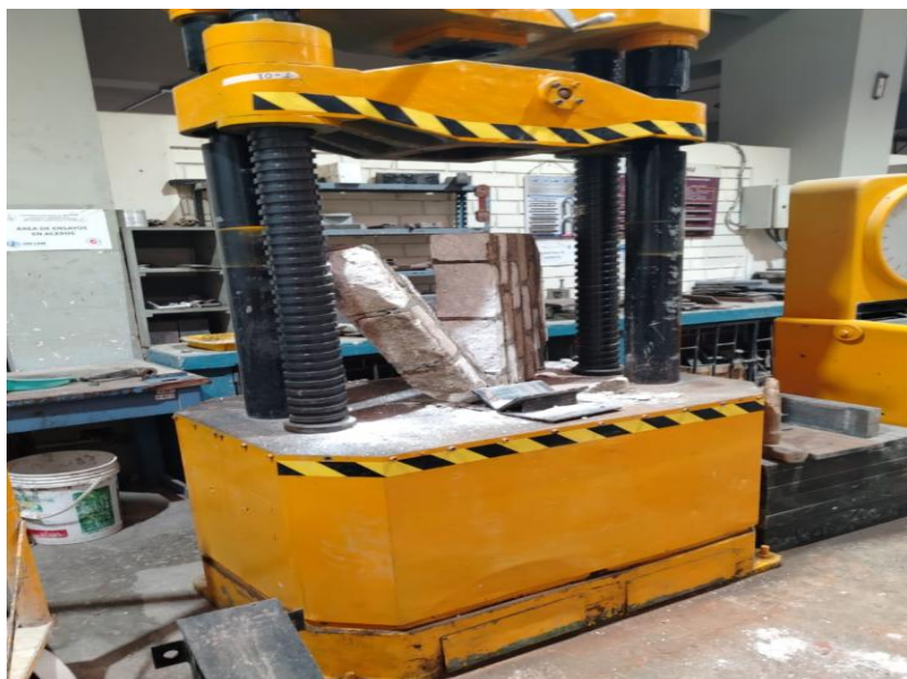
Foto 7: Ensayo de compresión de diagonal de muretes en muro de albañilería con ladrillos silico calcáreos bajo prensa hidráulica.
