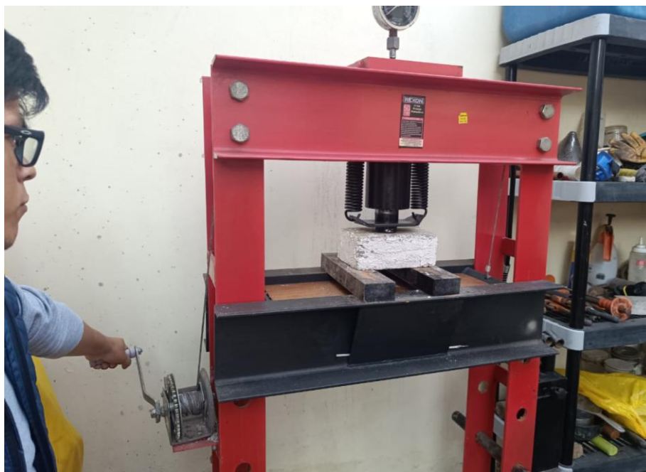
Foto 3: Ensayo de compresión en unidad de albañilería silico calcáreo.
