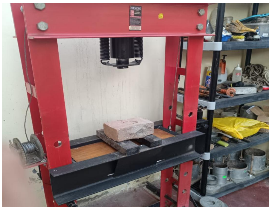
Foto 4: Ensayo de compresión en unidad de albañilería de arcilla.
