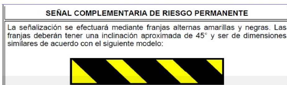
Figura 95. Señalización de riesgo permanente
