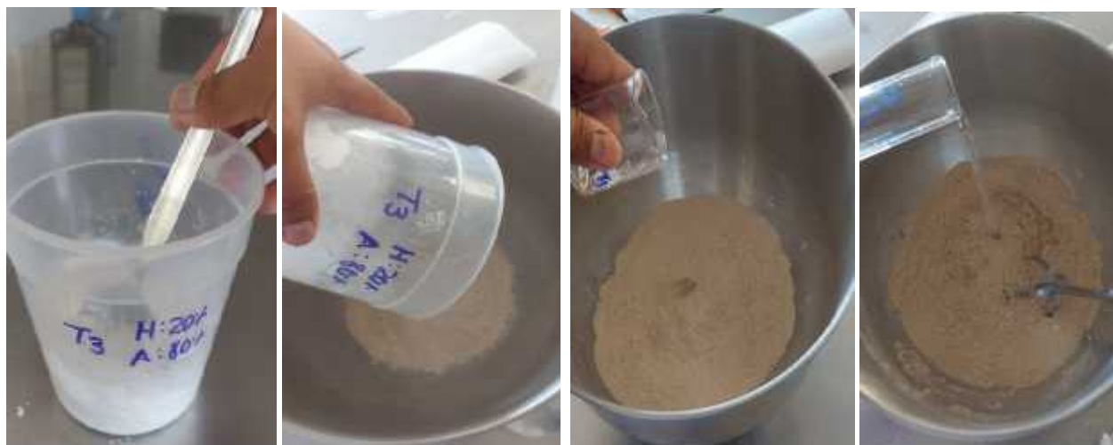
Materia seca añadida y pasada a un recipiente de aluminio Adición glicerol Adición H 2 O b) Mezclado
