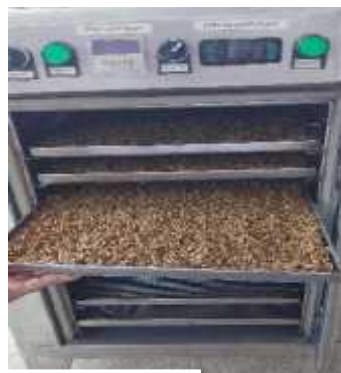
c) El Bagazo fue colocado en rejillas para luego se puestas en el horno.
