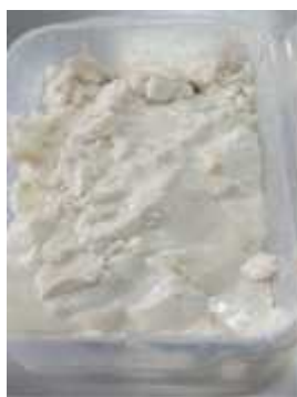
k) Almidón húmedo colocado en fuentes de plástico, que fueron llevados al horno, Secado
