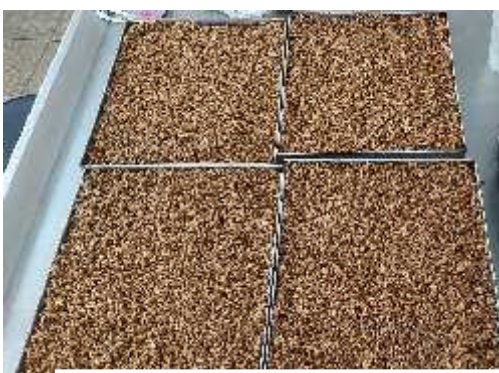
c) El Bagazo fue colocado en rejillas para luego se puestas en el horno.
