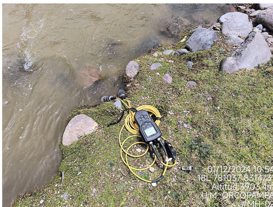
Figura 22. Medición de parámetros fisicoquímicos con multiparámetro
