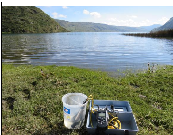
Fotografía 01: Medición de parámetros Físico-químicos de la estación LA-01
