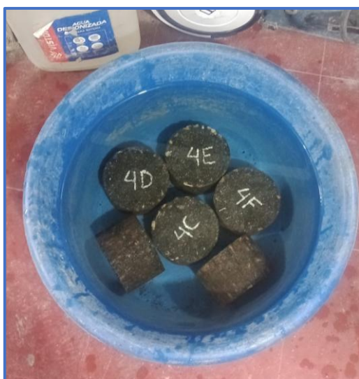
Fotografía 23. Gravedad específica bulk para determinar el % óptimo de asfalto residual.
