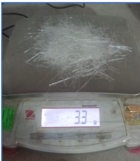
Fotografía 29. Inclusión de fibra de vidrio a la mezcla en frío.
