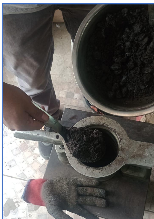
Fotografía 21. Elaboración de briquetas para determinar el % óptimo de asfalto residual.
