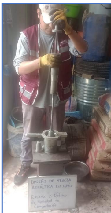
Fotografía 16. Elaboración de briquetas para el % óptimo de humedad de compactación.
