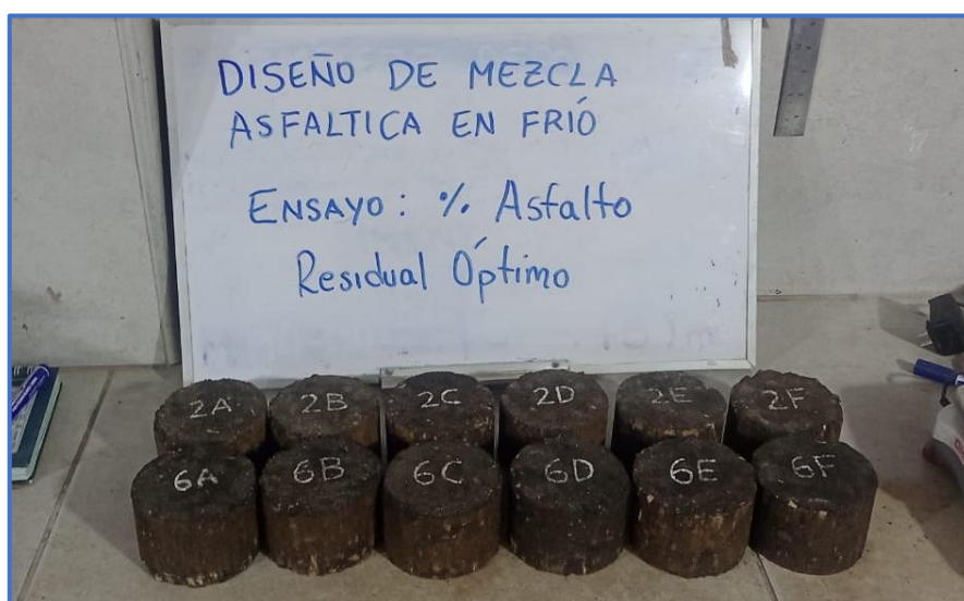
Fotografía 23. Gravedad específica bulk para determinar el % óptimo de asfalto residual.
