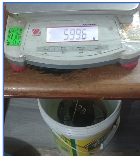
Fotografía 23. Gravedad específica bulk para determinar el % óptimo de asfalto residual.
