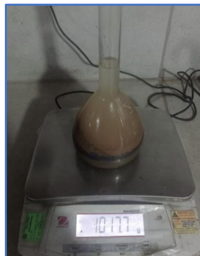
Fotografía 5. Ensayo de gravedad específica y absorción del agregado fino.
