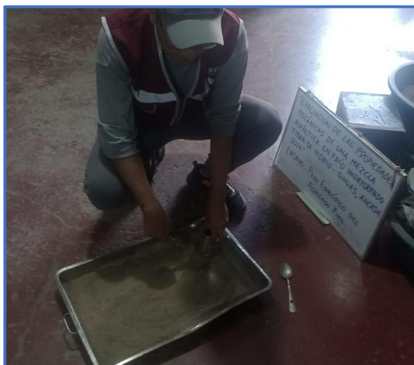
Fotografía 5. Ensayo de gravedad específica y absorción del agregado fino.
