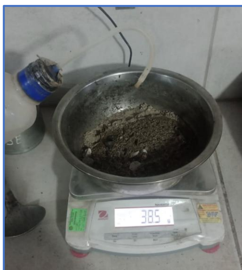
Fotografía 20. Elaboración de mezcla para determinar el % óptimo de asfalto residual.
