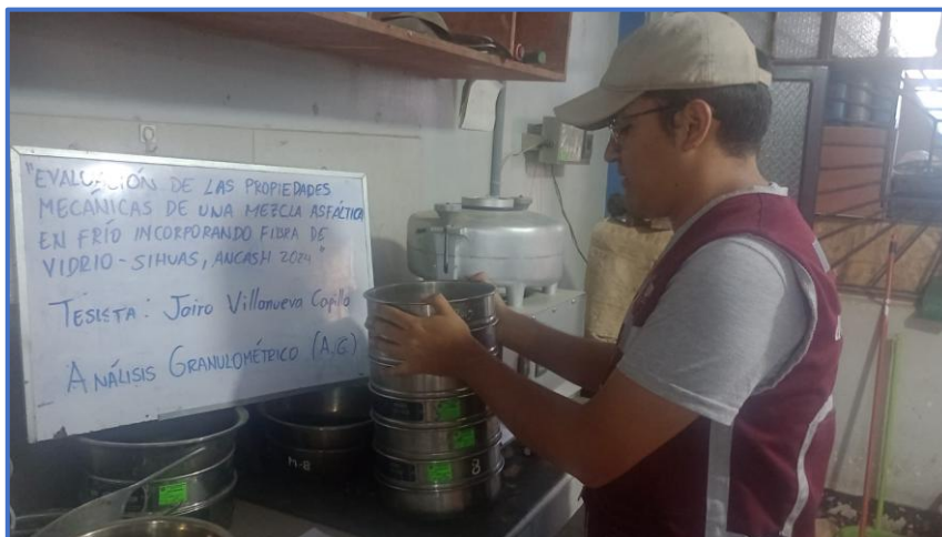
Fotografía 4. Saturación de los agregados para gravedad específica y absorción.
