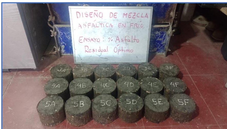
Fotografía 22. Briquetas con 2.7, 3.7, 4.7, 5.7 y 6.7% de asfalto residual.
