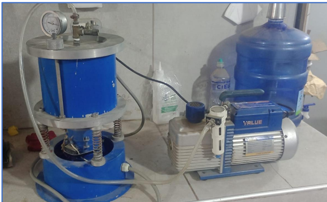
Fotografía 25. Inmersión y saturación al vacío de briquetas a una presión de 100 mm de Hg (3.9 in de Hg).
