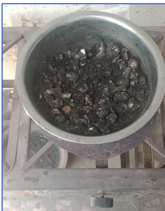
Fotografía 27. Secado de la briqueta ensayada para hallar el contenido de humedad.
