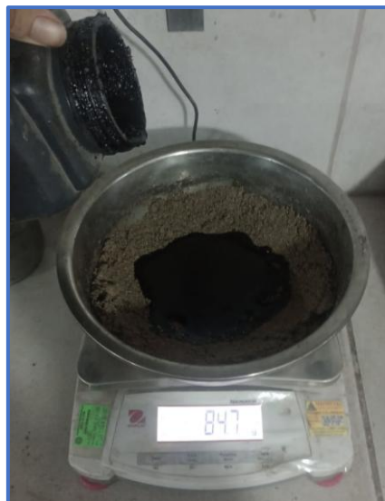
Fotografía 20. Elaboración de mezcla para determinar el % óptimo de asfalto residual.
