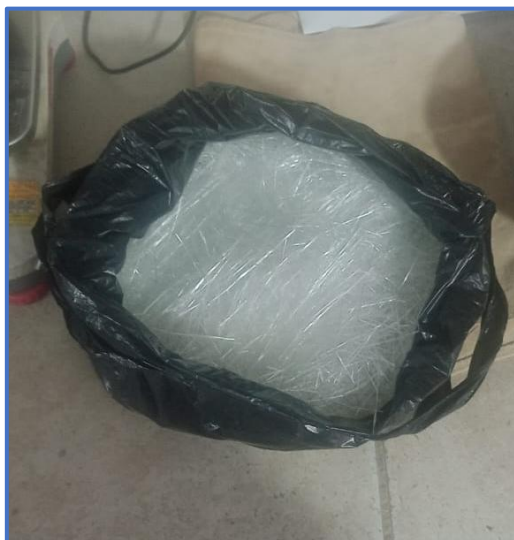
Fotografía 29. Inclusión de fibra de vidrio a la mezcla en frío.
