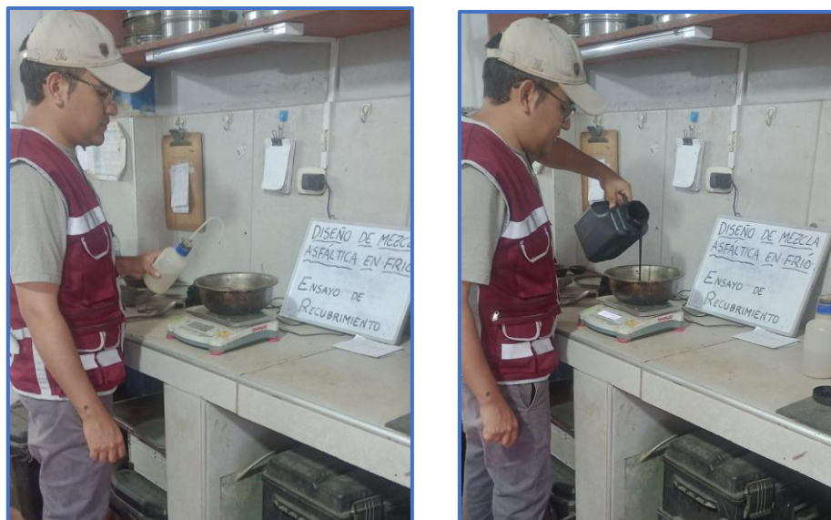
Fotografía 14. Agua y emulsión asfáltica para el ensayo de recubrimiento del agregado.
