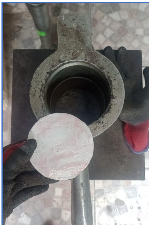
Fotografía 21. Elaboración de briquetas para determinar el % óptimo de asfalto residual.
