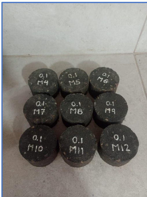
Fotografía 32. Briquetas con 0.1% de fibra de vidrio para prueba de hipótesis.
