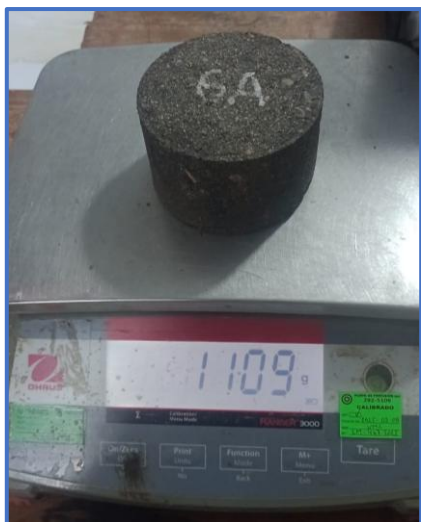
Fotografía 18. Peso al aire, SSS y sumergido de briquetas para gravedad específica bulk.
