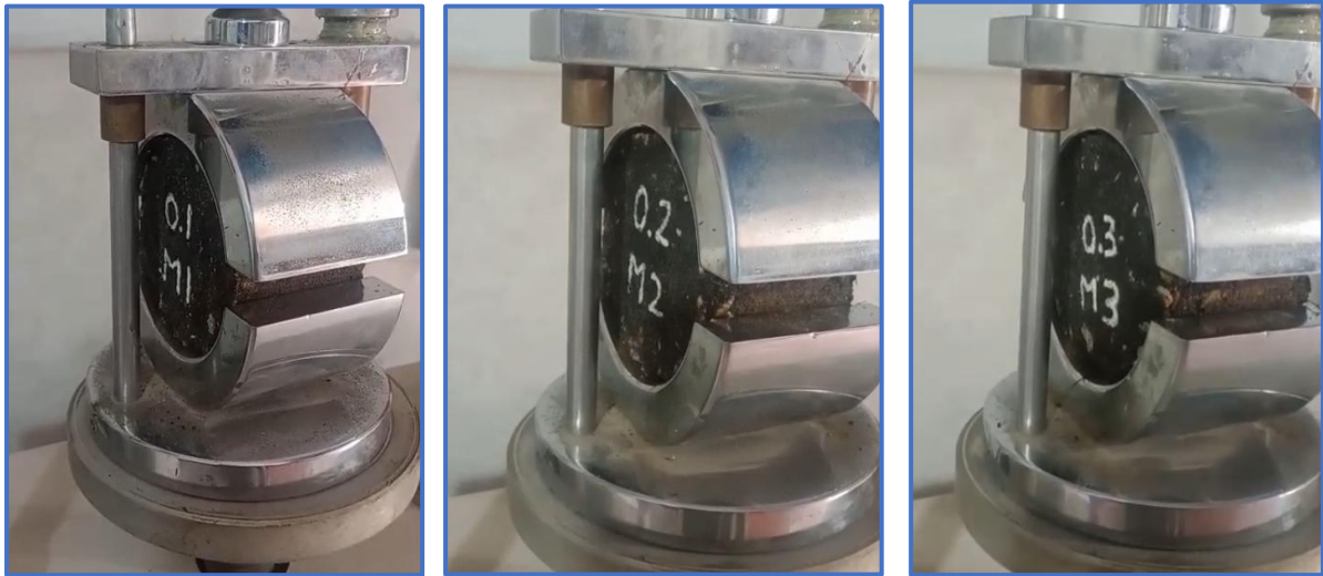
Fotografía 31. Ensayo de estabilidad y flujo de briquetas con fibra de vidrio.
