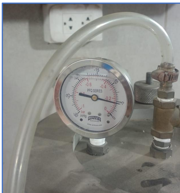
Fotografía 25. Inmersión y saturación al vacío de briquetas a una presión de 100 mm de Hg (3.9 in de Hg).
