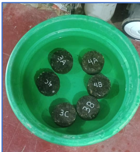
Fotografía 18. Peso al aire, SSS y sumergido de briquetas para gravedad específica bulk.
