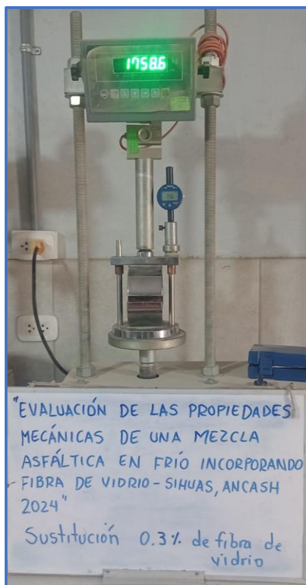
Fotografía 32. Briquetas con 0.1% de fibra de vidrio para prueba de hipótesis.
