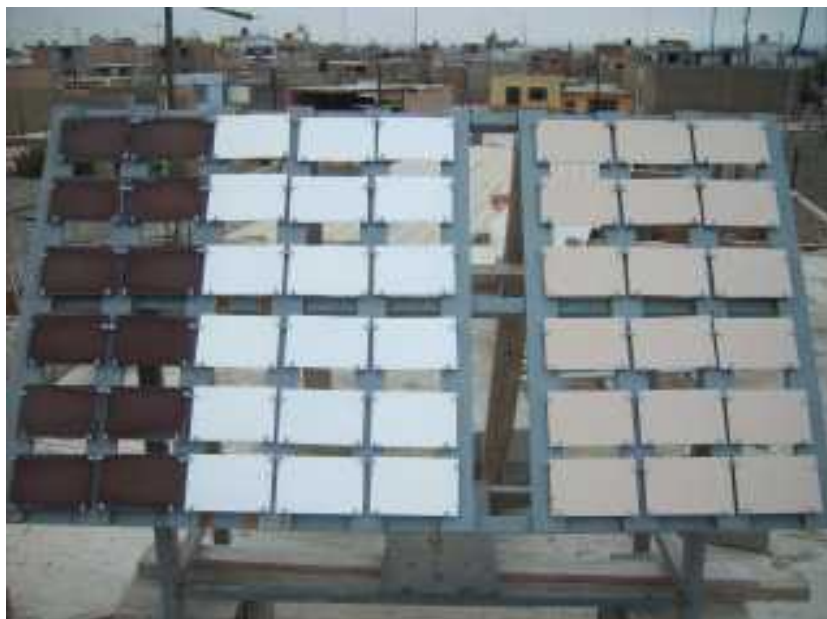
Figura 22. Detalle del bastidor porta muestras con la totalidad de placas del estudio: placas sin protección (bloque izquierdo de la foto); sistema de protección anticorrosivo, constituido por capa base é intermedia (bloque central) y capa base, intermedia y acabado (bloque derecho de la foto), respectivamente.
