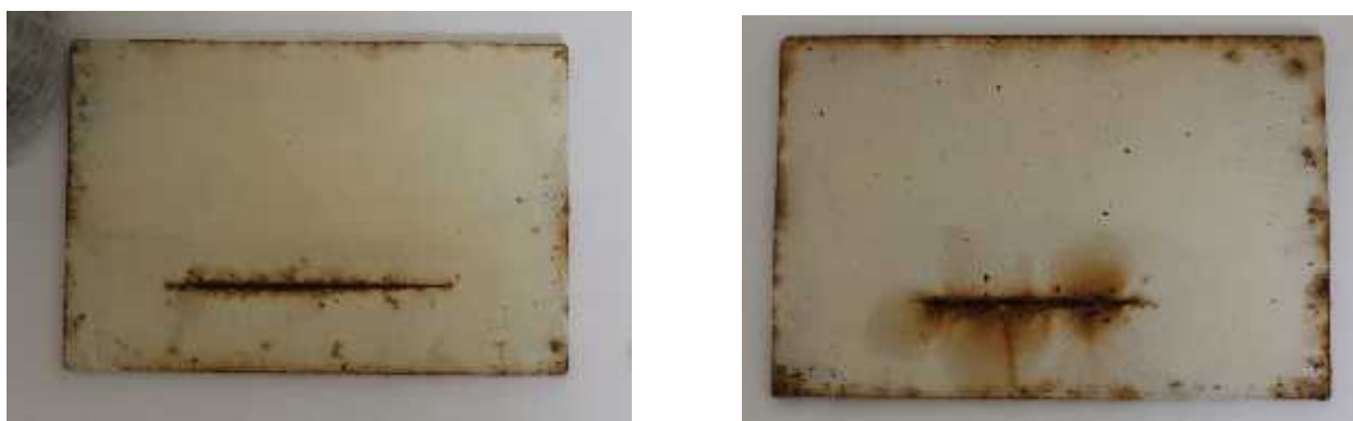
a) Capa base é intermedia, 9 meses de exposición b) Capa base é intermedia, 12 meses de exposición
