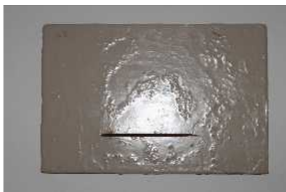
a) Capa base, intermedia y acabado, 3 meses de exposición b) Capa base, intermedia y acabado, 6 meses de exposición.
