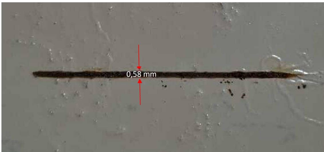
Figura 43. Incisión sobre una placa de acero con capa base, intermedia y acabado, y 3 meses de exposición a una atmósfera corrosiva marina. No se observa ensanchamiento de incisión (0,58 mm)-
