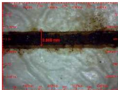
Figura 48. Imagen de acercamiento con microscopio digital de placa de acero con capa base, intermedia y acabado, retirada a los 15 meses de exposición, (corrosión filiforme). Se observa el ancho de la incisión en 0,866 mm. También se aprecia pequeñas nervaduras localizadas correspondiendo a la formación de corrosión filiforme. X1000.
