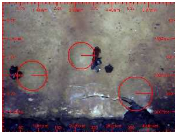
Figura 38. Placa de acero con capa base é intermedia retirada a los 15 meses de exposición. Se observa agrietamiento y pérdida de la capa protectora. X 1000.
