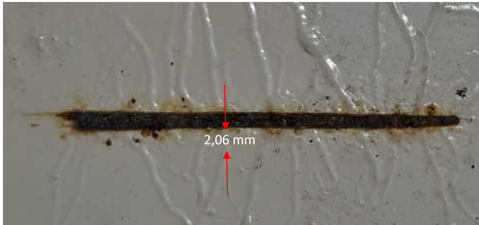
Figura 47. Incisión sobre una placa de acero con capa base, intermedia y acabado, y 15 meses de exposición a una atmósfera corrosiva marina. Notorio ensanchamiento de incisión (2,06 mm). Avance de corrosión filiforme
