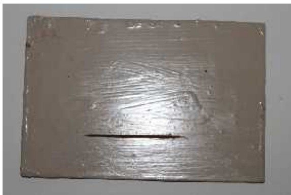
a) Capa base, intermedia y acabado, 9 meses de exposición b) Capa base, intermedia y acabado, 12 meses de exposición
