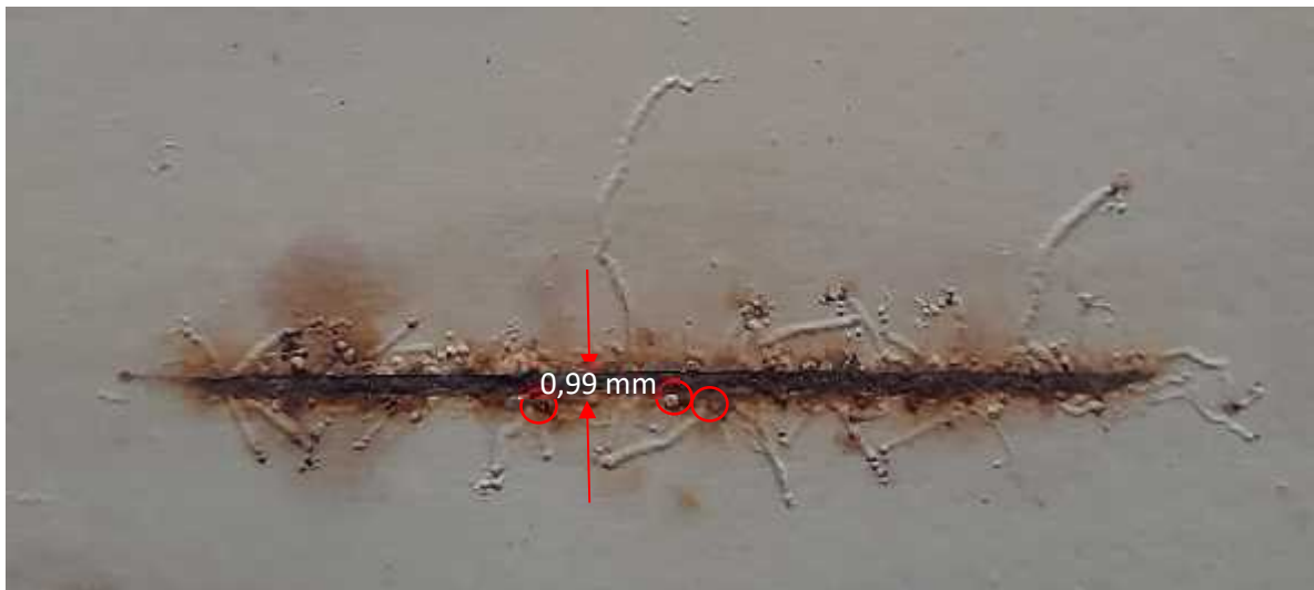
Figura 32. Incisión con un ancho de 0,99 mm en una placa de acero con capa base é intermedia a los 6 meses de exposición a una atmósfera corrosiva marina. Se aprecia el progreso de la corrosión filiforme. Formación de pequeñas "cabezas" (círculos rojos), desde donde se proyectan las "colas" (nervaduras)
