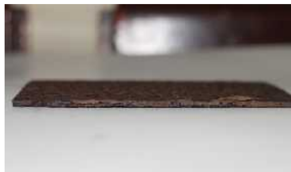
b) Borde de placa de acero con 15 meses de exposición
