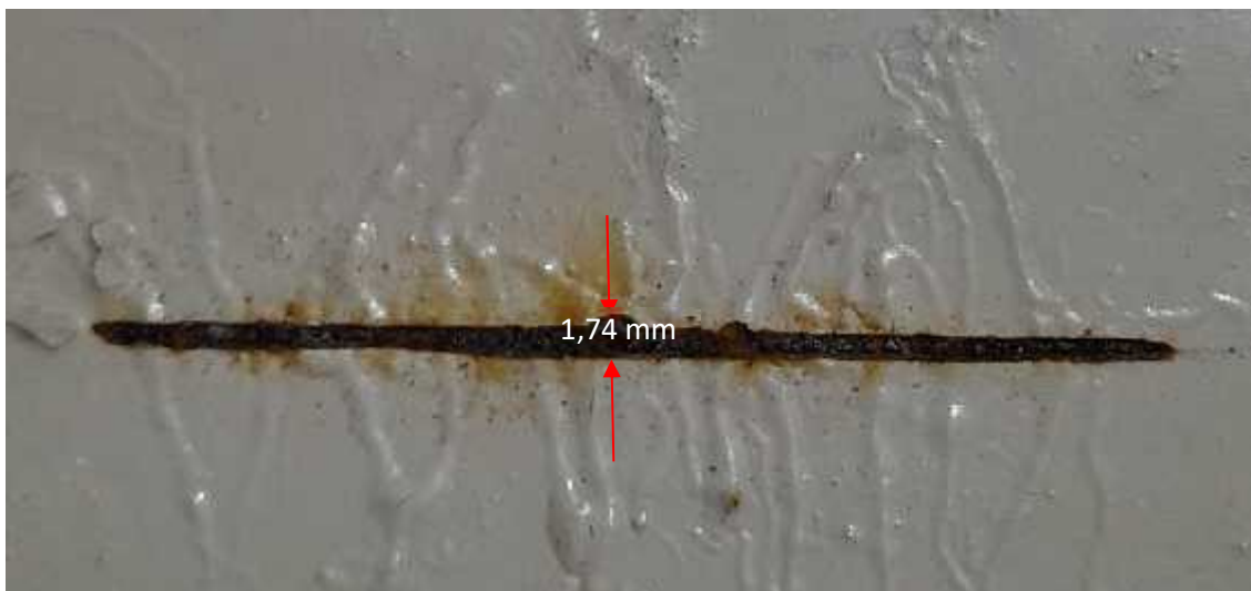
Figura 46. Incisión sobre una placa de acero con capa base, intermedia y acabado, y 12 meses de exposición a una atmósfera corrosiva marina. Ligeró ensanchamiento de incisión (1,74 mm). Corrosión filiforme.
