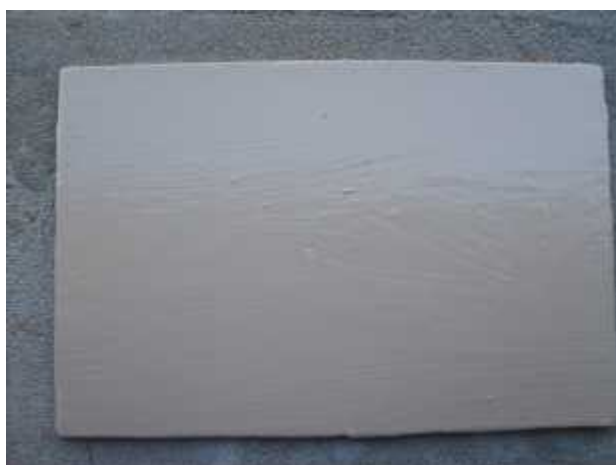
Figura 19. Una de las 18 placas de acero con capa base, intermedia y acabado. La capa de acabado pose alto contenido de sólidos en volumen (50%).
