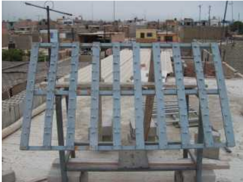
Figura 14. Estructura de madera (bastidor) porta muestras para exposición. Ubicado en el tercer piso de una vivienda de la Urb. La Libertad, Chimbote, Perú a 197m del mar.
