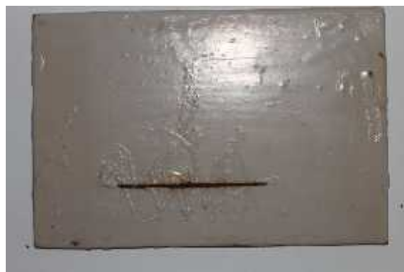
a) Capa base, intermedia y acabado, 9 meses de exposición b) Capa base, intermedia y acabado, 12 meses de exposición
