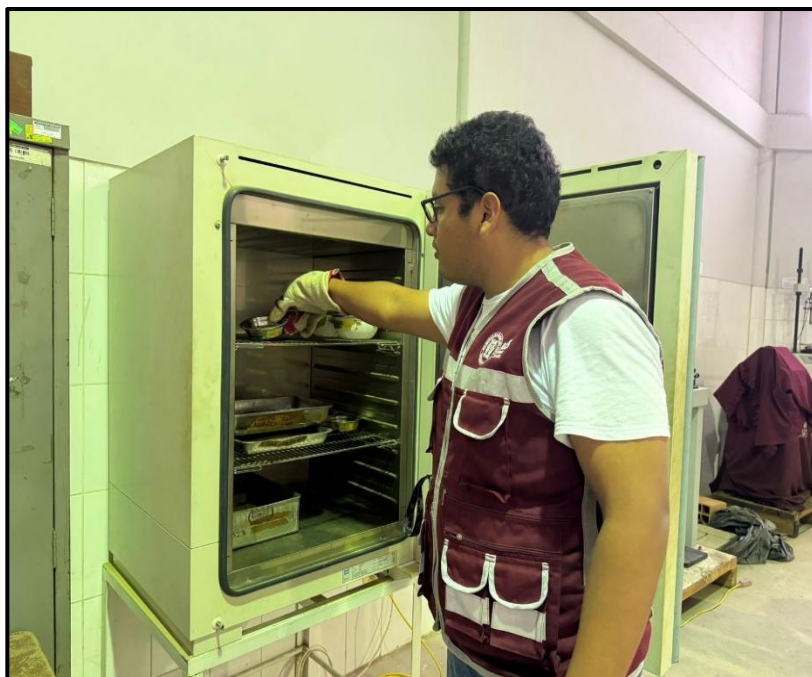
Foto 16: Colocación de la muestra al Horno para determinar el contenido de humedad.
