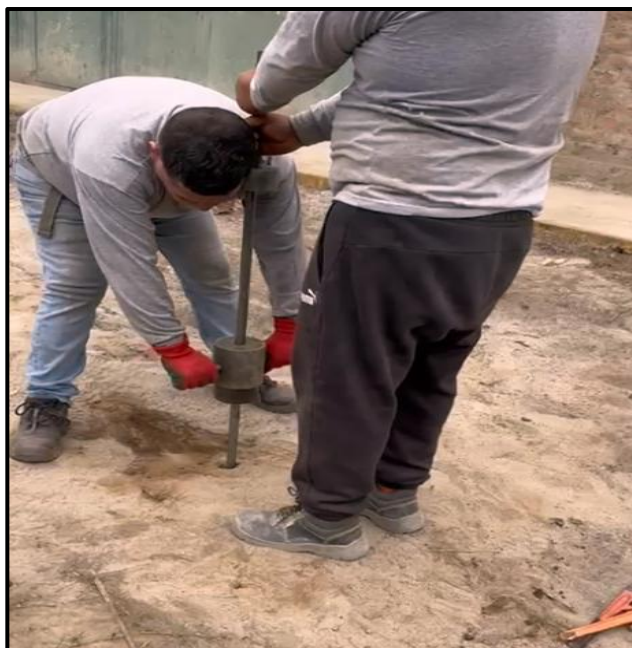
Foto 8: Hincado y registro del número de golpes en incrementos de 10 cm.
