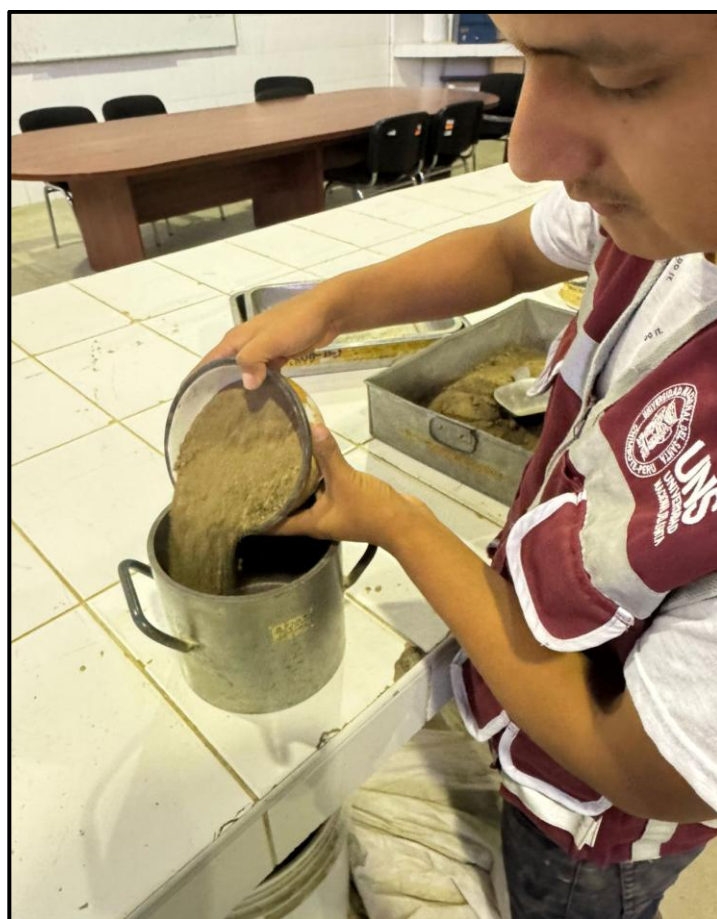
Foto 23: Colocación de la muestra seca suelta para obtener la Densidad Mínima.
