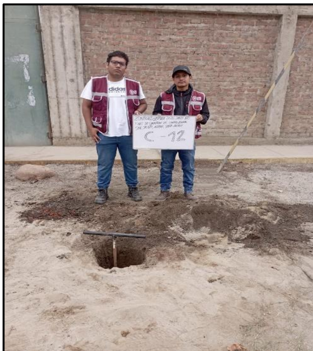
Foto 1: Extracción de muestras en distintos sectores del Centro Poblado San Jacinto (Calicata 12) por parte de los tesistas.
