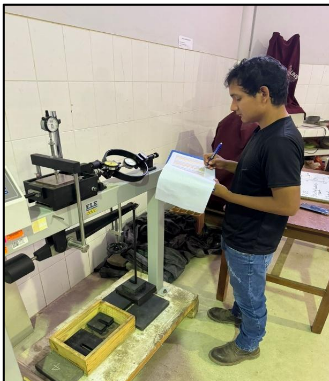
Foto 12: Lectura de los diales del ensayo de corte directo.
