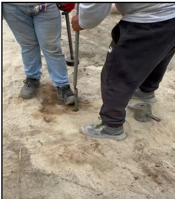
Foto 9: Agregar secciones de varilla a la varilla de penetración a medida que se introduce en el suelo para alcanzar mayores profundidades.
