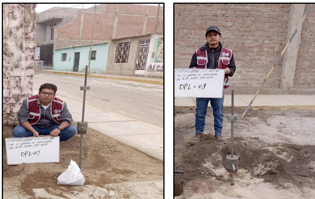
Foto 6: Realización del ensayo de DPL por parte de los tesistas.
