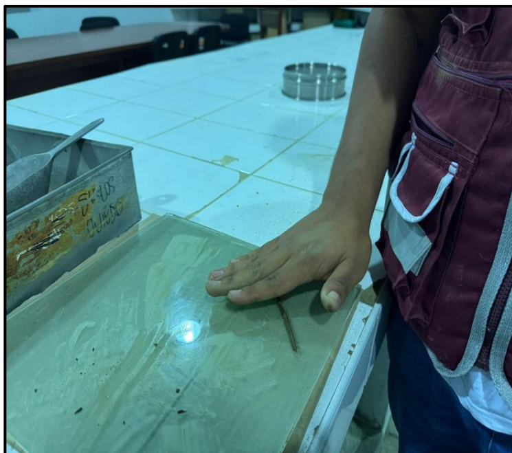
Foto 22: Hilos de suelo de aproximadamente 3 mm de diámetro para el Limite Plástico (LP).
