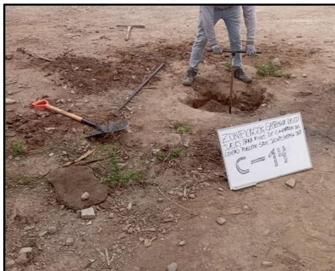
Foto 3: Uso de posteadora manual para llegar a mayores profundidades (C-14).
