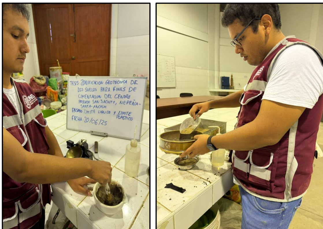
Foto 20: Preparación de la muestra para realizar los límites de Atterberg.
