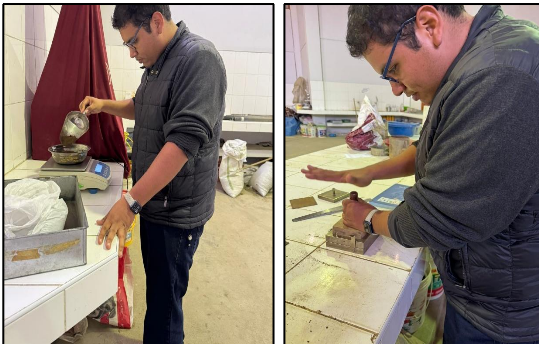
Foto 10: Preparación de la muestra para realizar el ensayo de corte directo.
