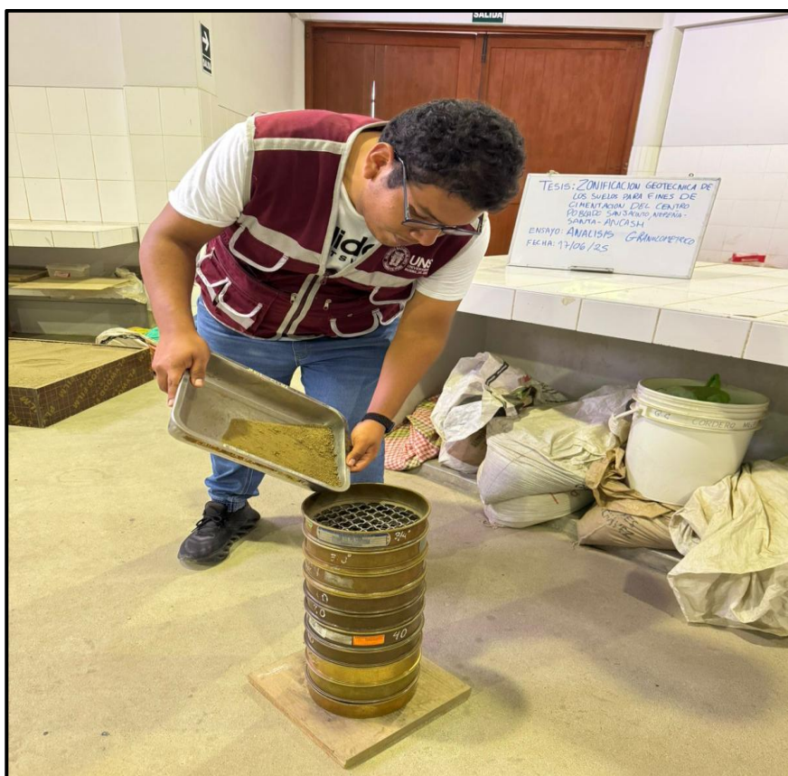
Foto 19: Colocación de la muestra seca en los tamices.
