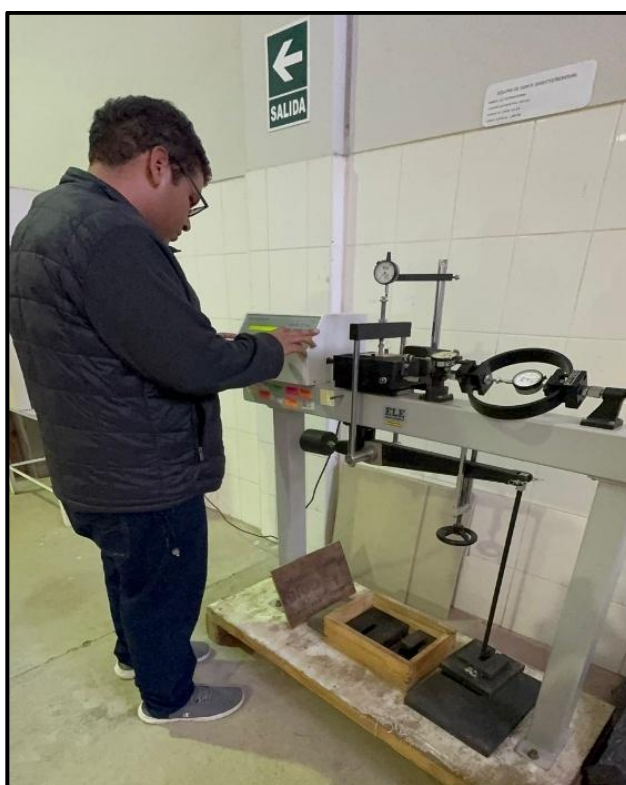
Foto 11: Manipulación de la máquina de ensayo de corte directo, nivelación de los discos de carga para realizar el ensayo.
