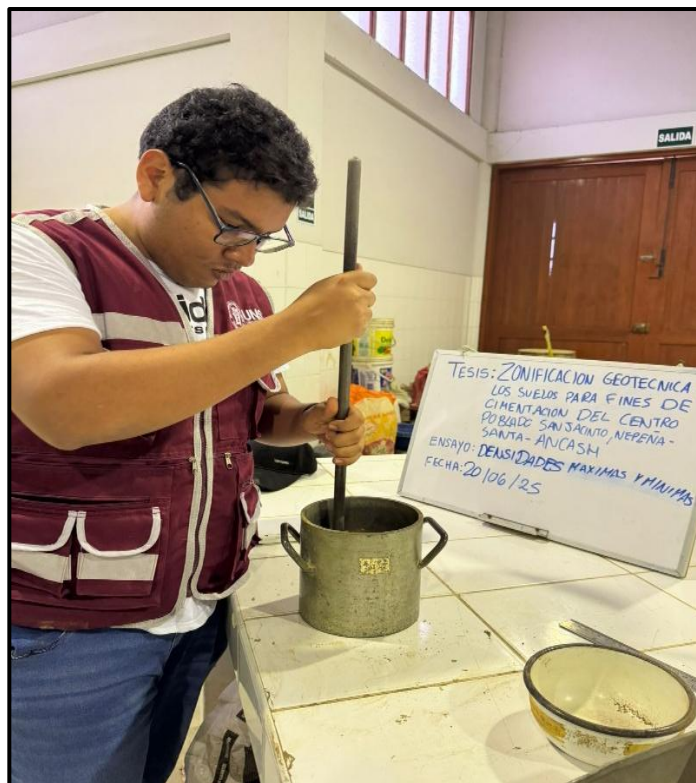
Foto 24: Colocación y compactación de la muestra seca para obtener la Densidad Máxima.
