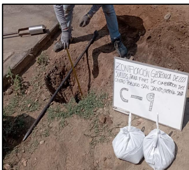
Foto 4: Tomado de muestras del suelo a distintos estratos (C-9).
