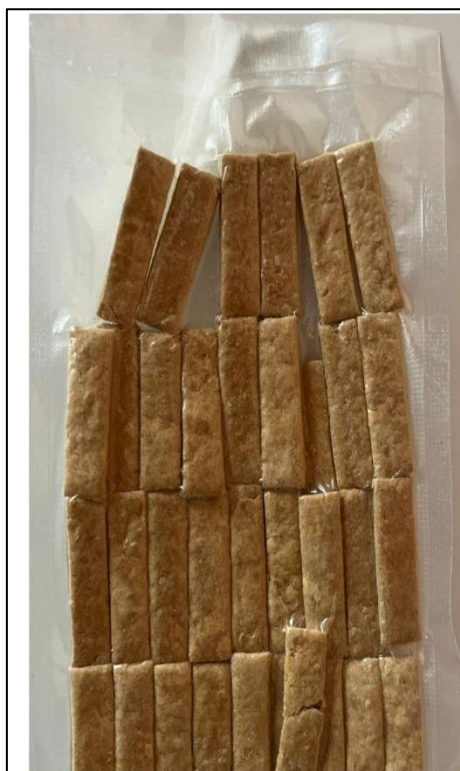
Muestras para determinar las propiedades mecánicas de tracción (80 mm x 25 mm)
