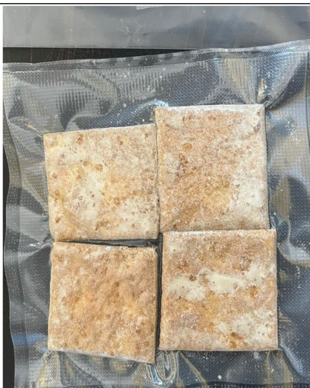
Muestras para determinar las propiedades mecánicas de perforación (50 mm x 50 mm)
