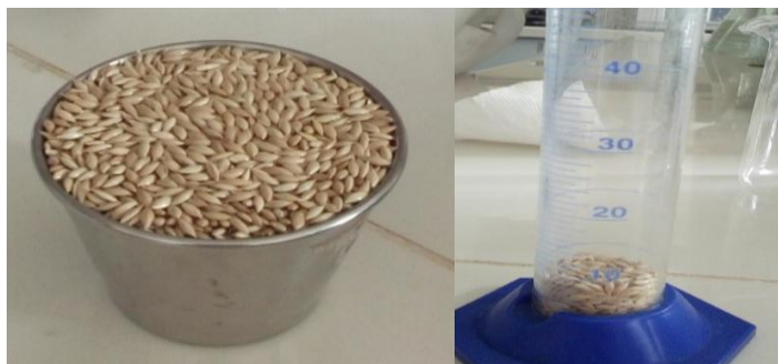
Imagen 27: Determinación del volumen específico de las galletas
