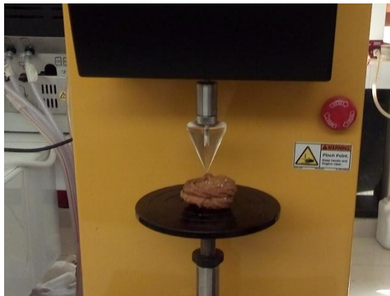
Imagen 31: Determinación de textura utilizando el texturómetro
