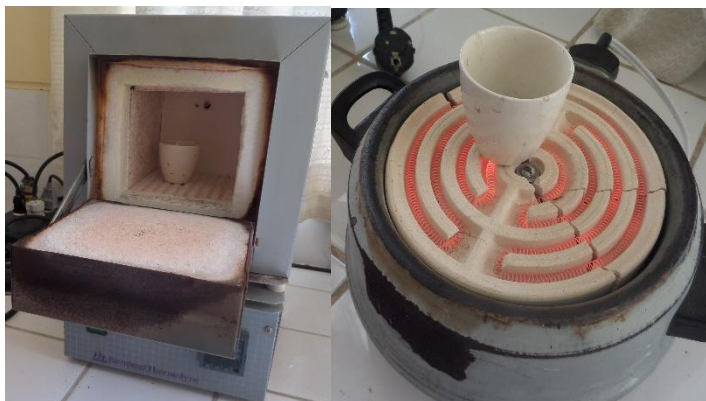
Imagen 33: Determinación de cenizas utilizando la mufla
