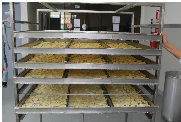
Imagen 6: Secado del camote utilizando el secador de bandejas
