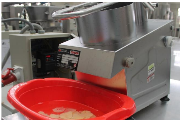
Imagen 5: Cortado del camote utilizando una cortadora
