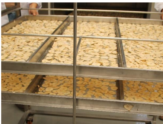
Imagen 13: Secado de los plátanos en rodajas utilizando el secador de bandejas.
