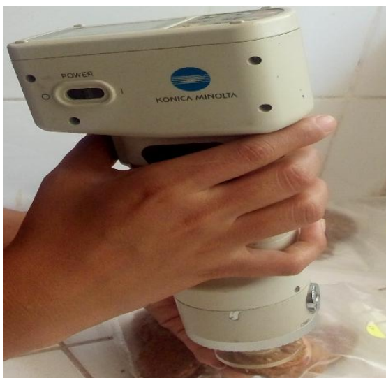
Imagen 25: Evaluación del color de las galletas utilizando el método CIELAB.
