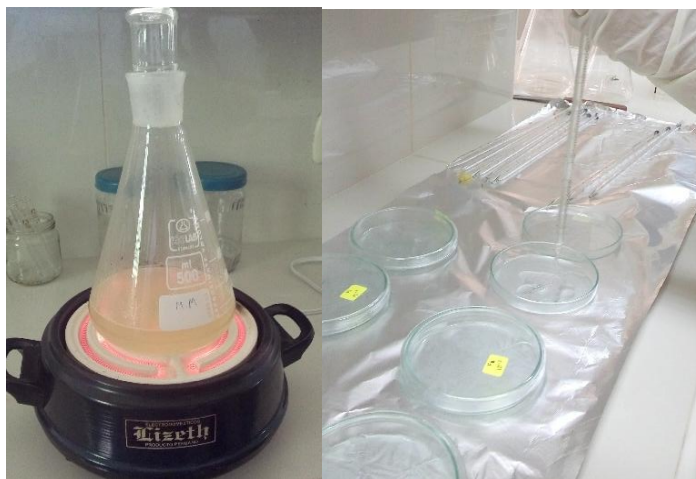
Imagen 35: Determinación de mohos mediante el método de superficie de placa
