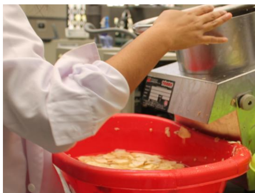
Imagen 12: Cortado del plátano utilizando la rodajadora industrial
