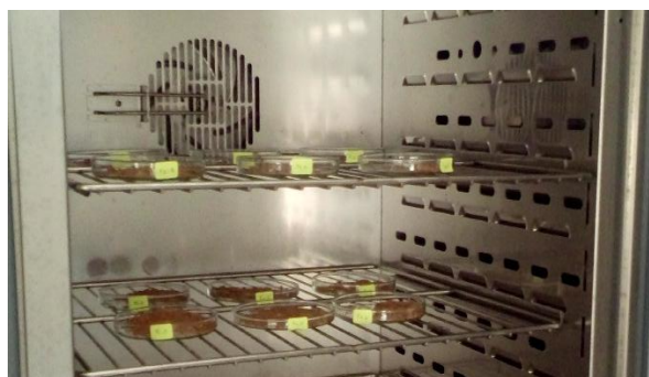
Imagen 32: Determinación de la humedad utilizando la estufa
