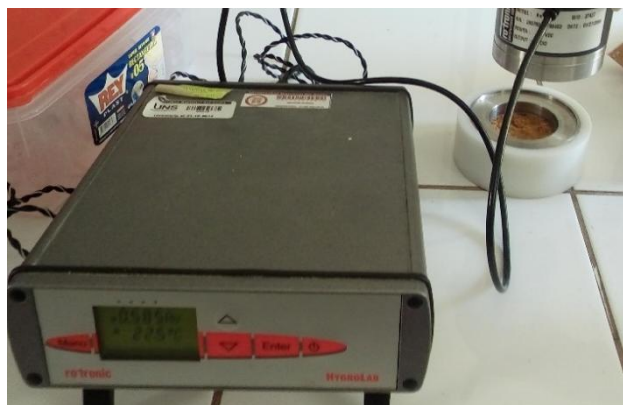
Imagen 28: Medición de la función del agua utilizando el higrómetro.
