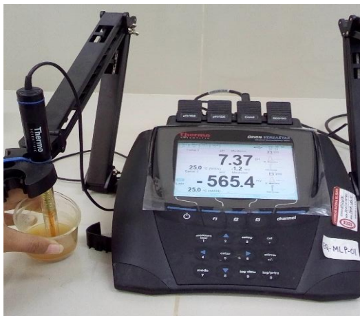
Imagen 26: Medición del pH en galletas mediante un medidor multiparámetros
