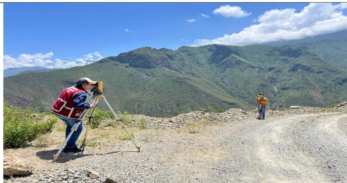
*Fig N° 9.9. Se observa la toma de puntos, en esta ocasión, luego de un cambio de estación con reorientación*
