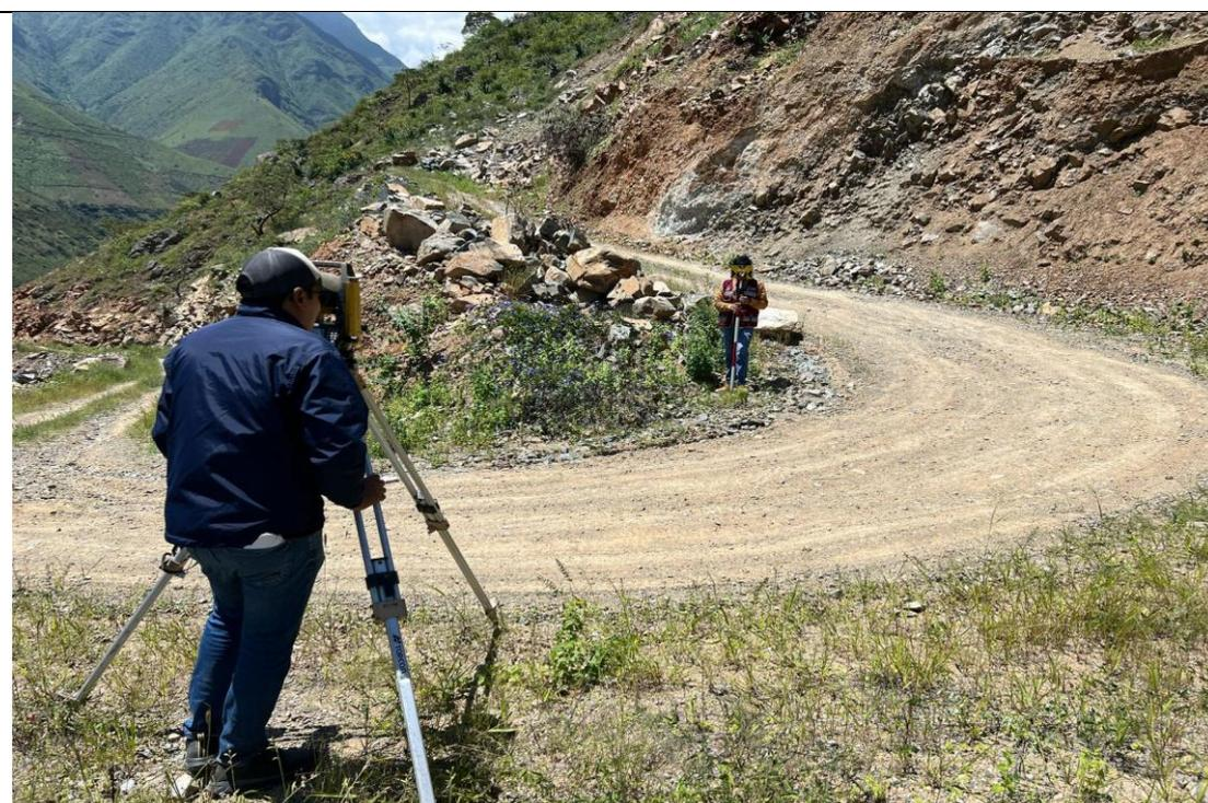
*Fig N° 9.12. Calibración del equipo topográfico luego de cambio de estación con reorientación – Progresiva 2+185*
