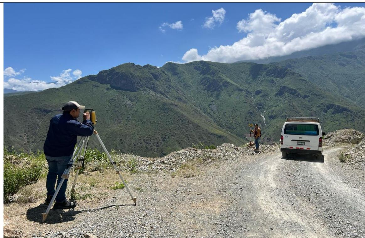
*Fig N° 9.11. Obtención de puntos para levantamiento de eje longitudinal y secciones transversales de la carretera*
