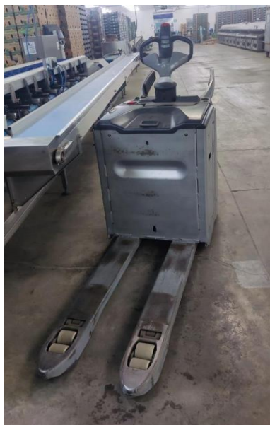
Figura 37 Foto de stocka eléctrica de TAL S.A.
