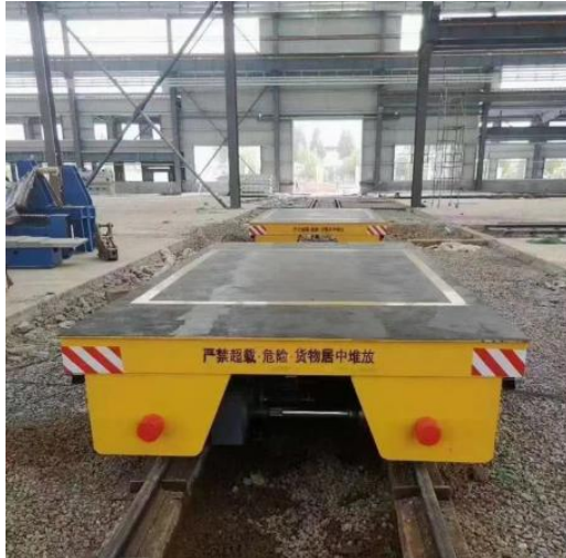
Carro de Transferencia Accionado por Rieles Eléctricos
