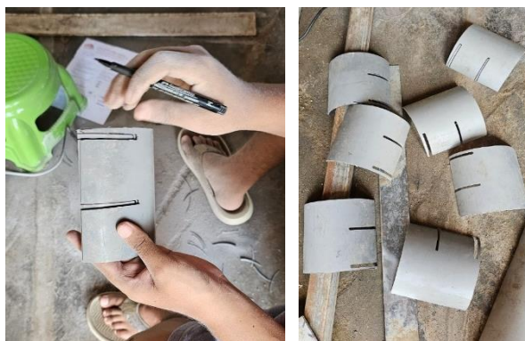
Figura 25 Corte de ranuras a las palas del rotor
