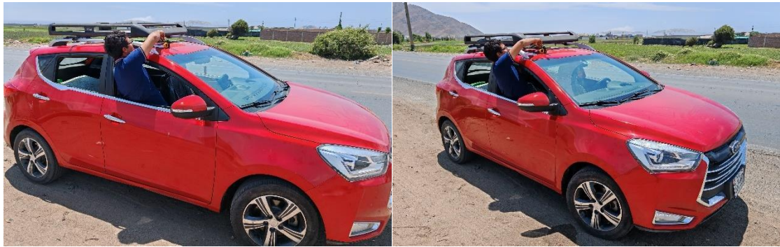
Figura 22 Mediciones de velocidad de viento en el techo
