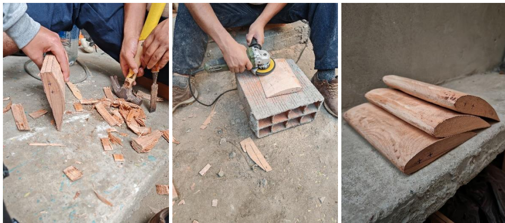
Figura 31 Fabricación de los álabes de madera
