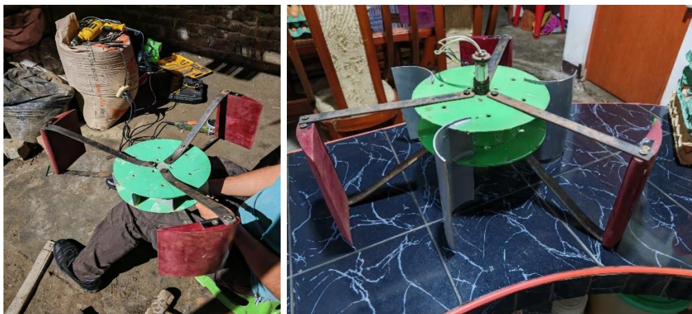
Figura 32 Fijación de los álabes al generador eléctrico
