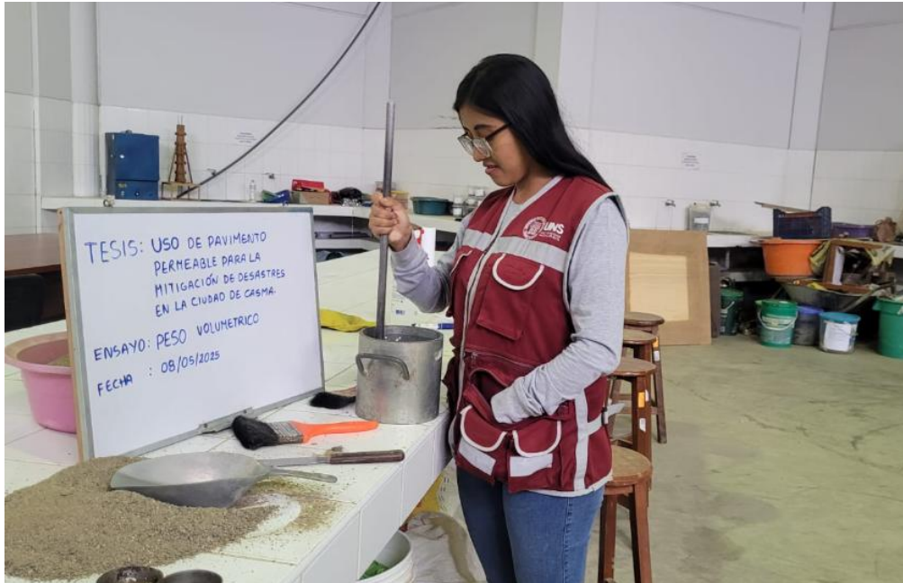
Foto 13. Compactación del agregado
