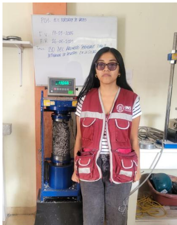
Foto 52. Probeta 2 – 15% de vacío
