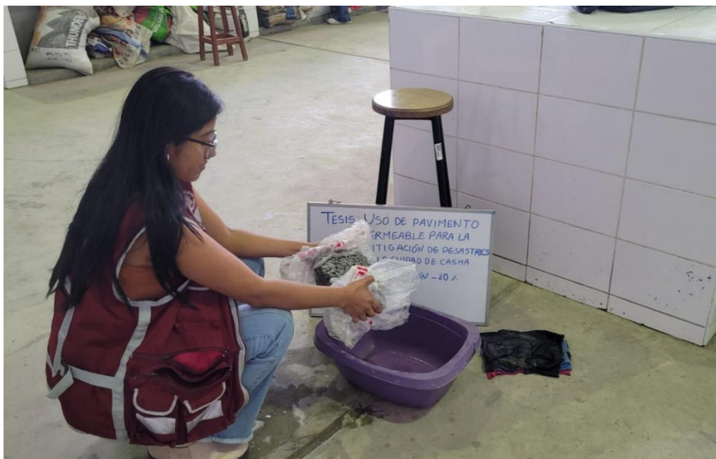
Foto 80. Prueba de escorrentía superficial con concreto 20% vacío
