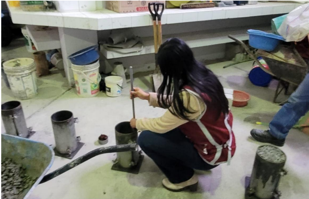
Foto 45. Compactación del concreto en las probetas
