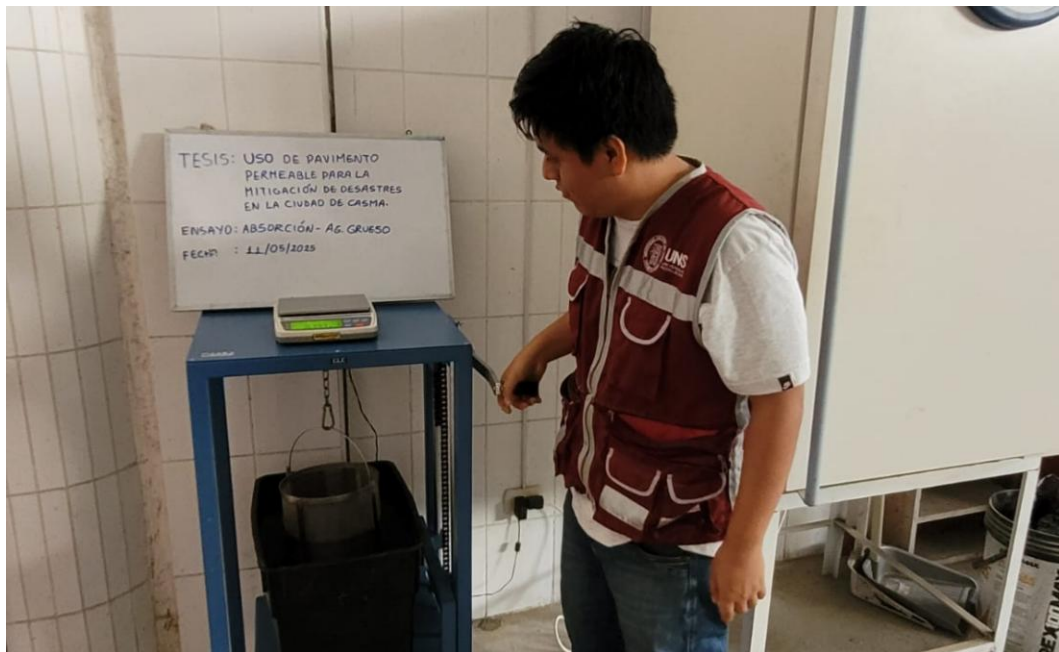
Foto 40. Peso de la muestra sumergida en agua
