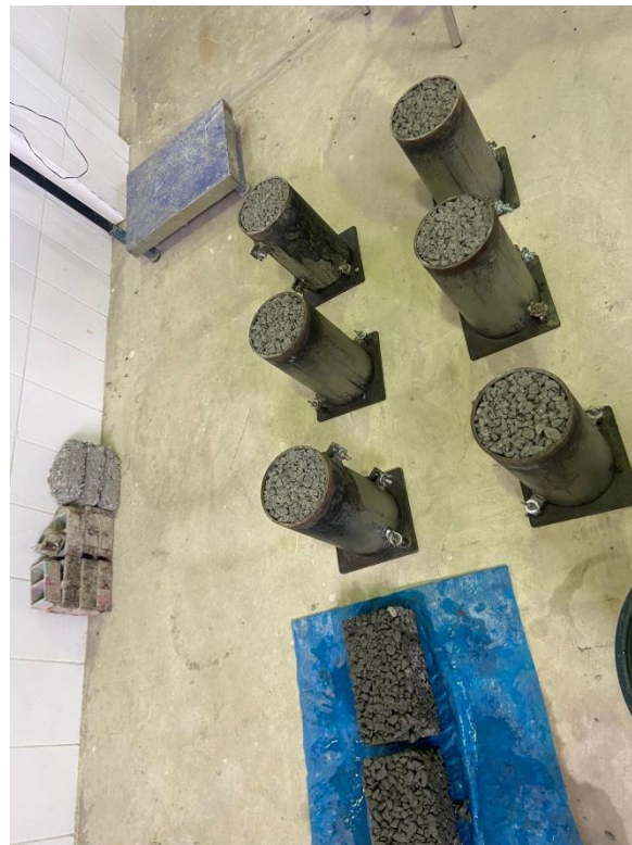
Foto 46. Probetas con 15% de porcentaje de vacío
