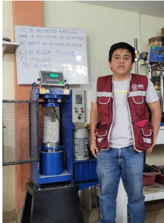
Foto 69. Probeta 1 – 35% de vacío
