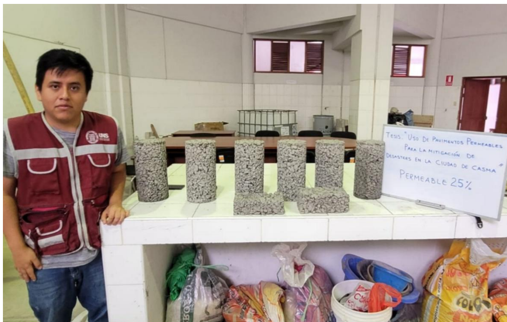
Foto 48. Probetas con 25% de porcentaje de vacío
