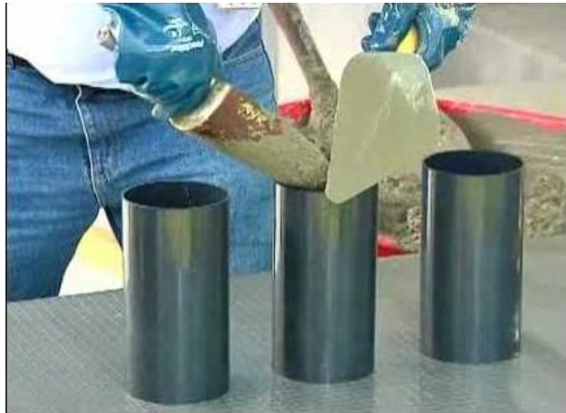
Figura 2. Llenado de probetas para el ensayo de compresión de concreto
