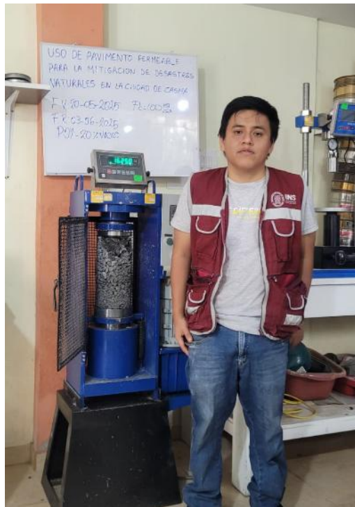
Foto 63. Probeta 1 – 20% de vacío
