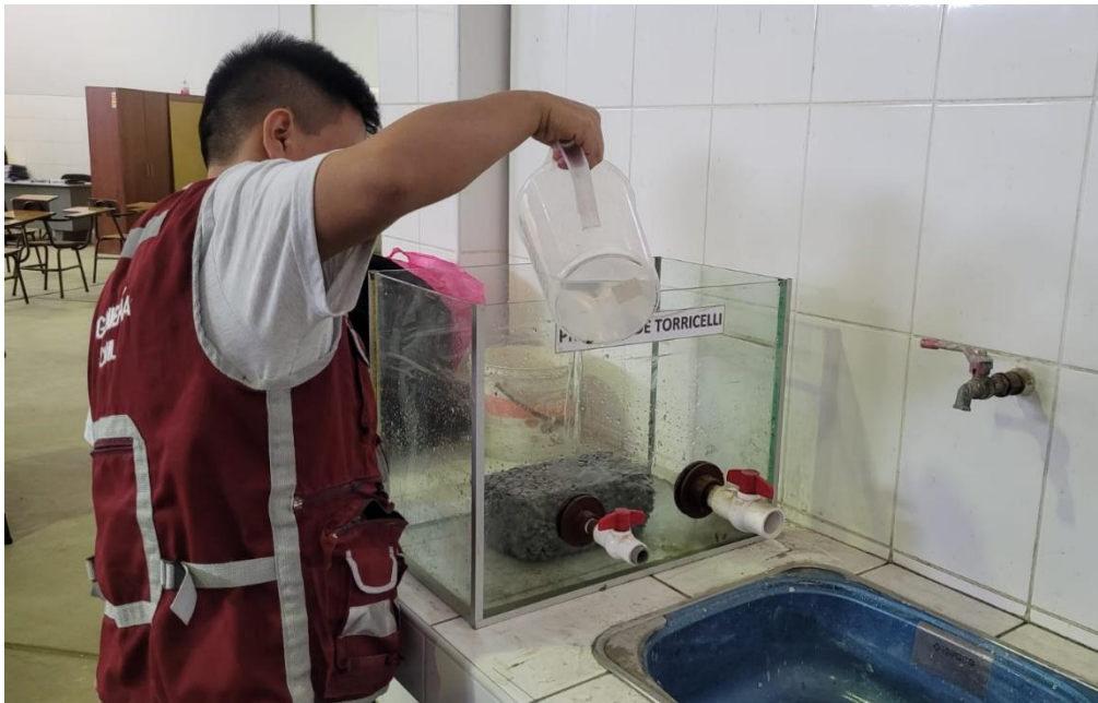
Foto 85. Prueba de infiltración con concreto 20% vacío
