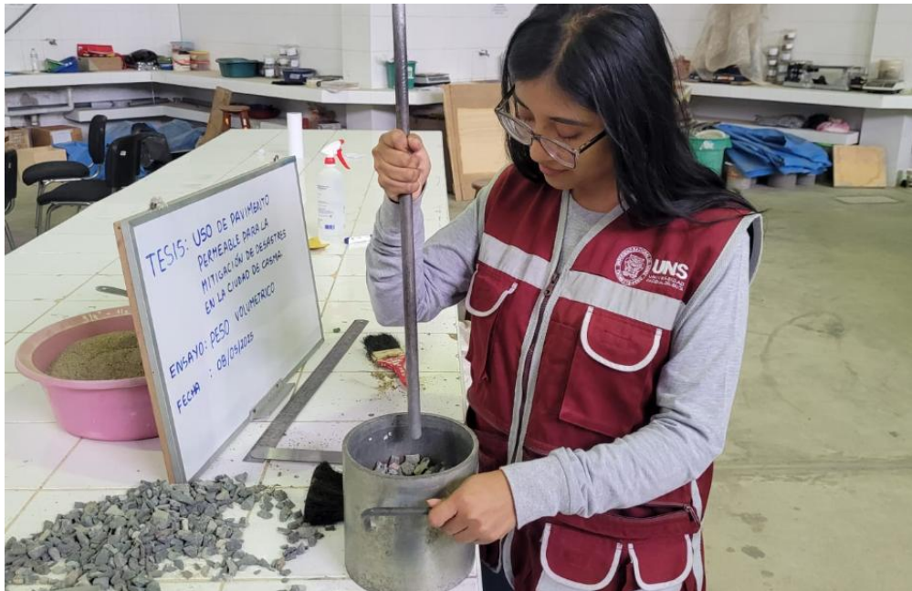
Foto 35. Compactación del agregado
