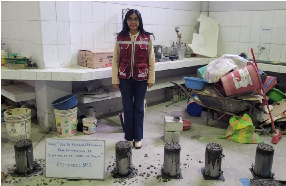
Foto 49. Probetas con 30% de porcentaje de vacío
