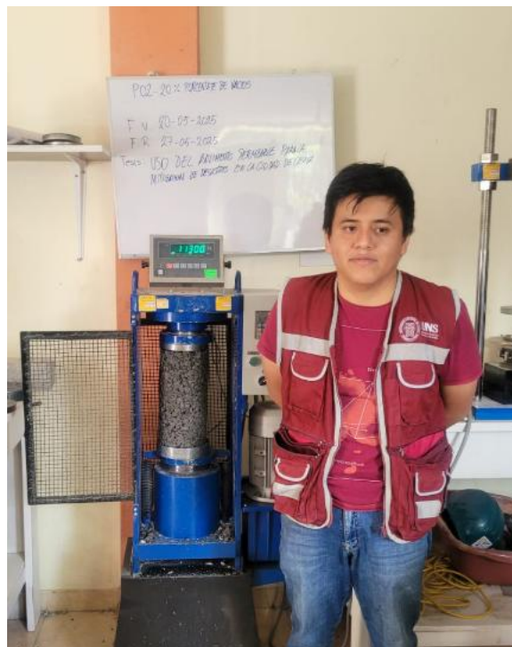
Foto 54. Probeta 2 – 20% de vacío
