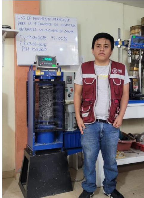
Foto 62. Probeta 2 – 15% de vacío
