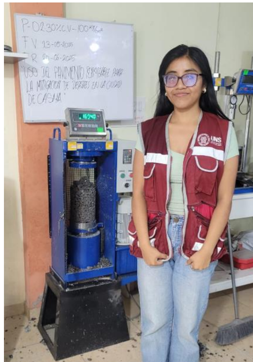
Foto 76. Probeta 2 – 30% de vacío
