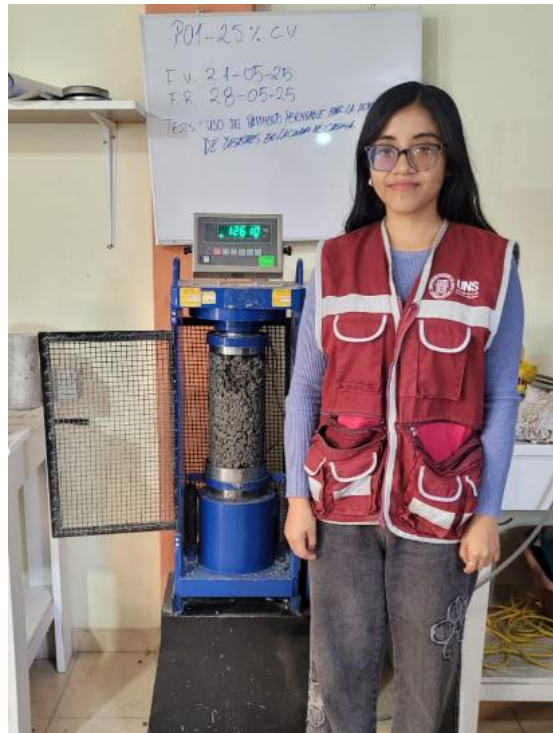
Foto 55. Probeta 1 – 25% de vacío
