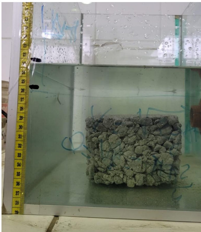
Foto 88. Prueba de infiltración con concreto 35% vacío
