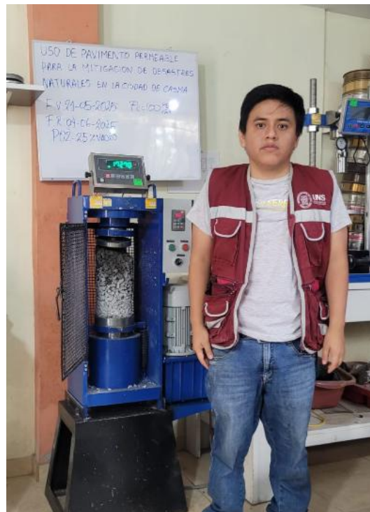
Foto 66. Probeta 2 – 25% de vacío
