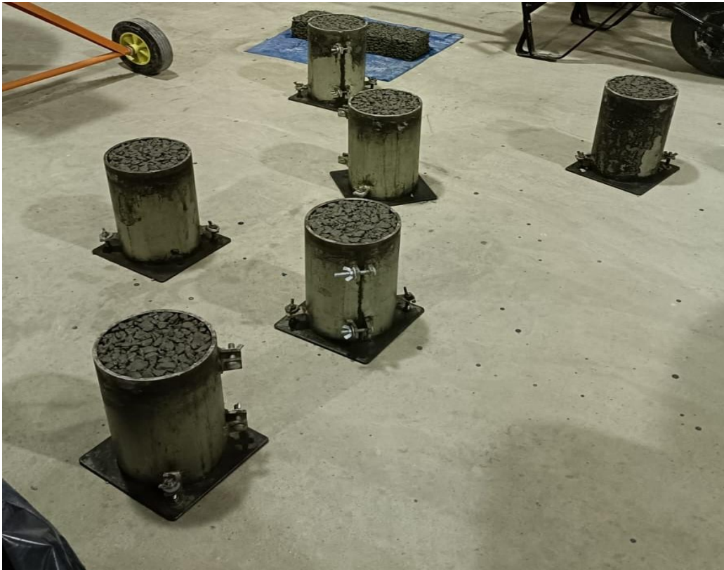
Foto 47. Probetas con 20% de porcentaje de vacío
