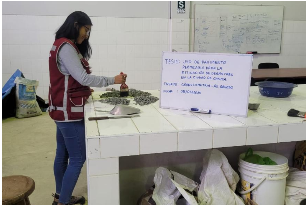
Foto 29. Cuarteo del Agregado Grueso
