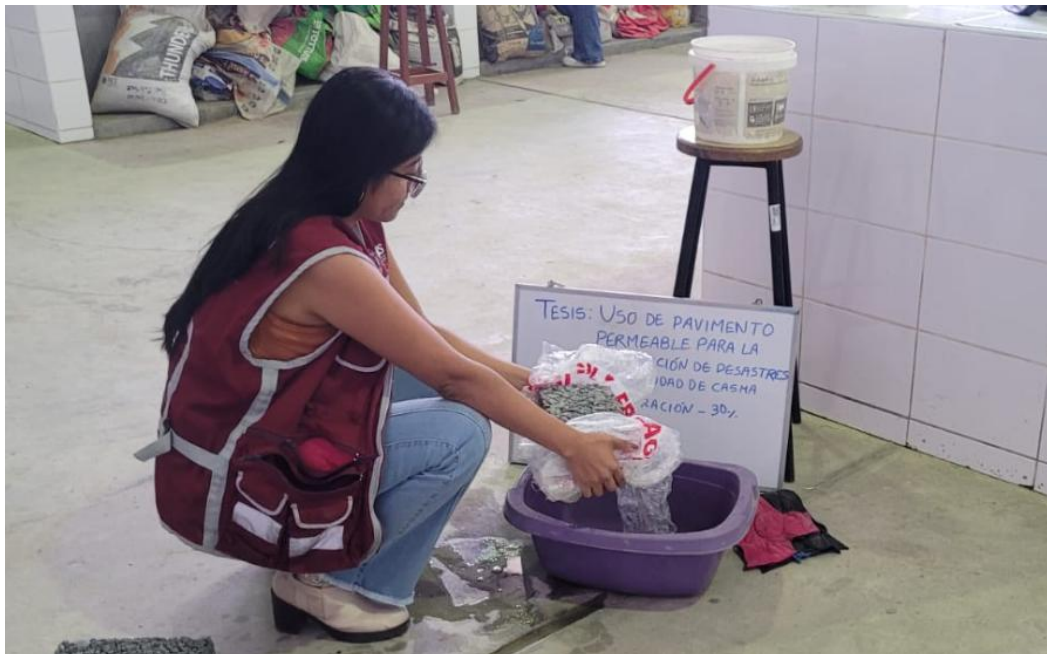
Foto 82. Prueba de escorrentía con concreto 30% vacío
