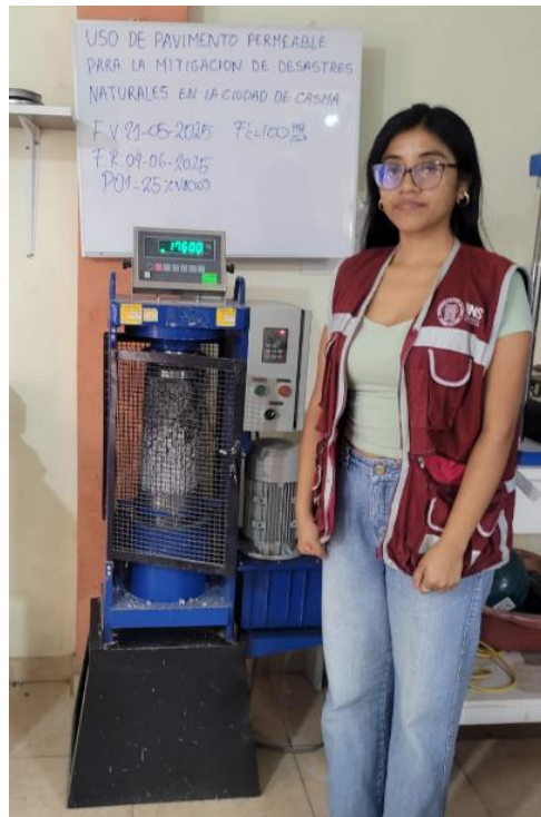
Foto 65. Probeta 1 – 25% de vacío
