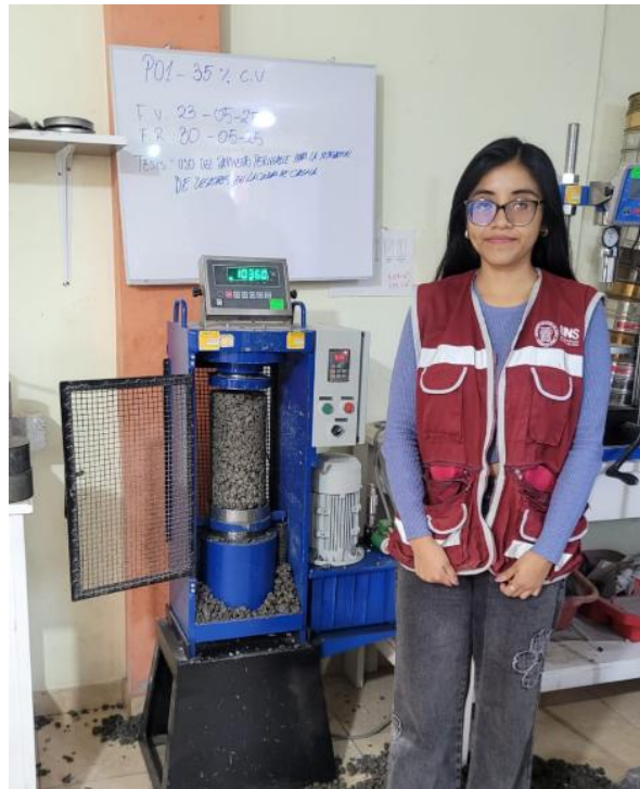
Foto 59. Probeta 1 – 35% de vacío
