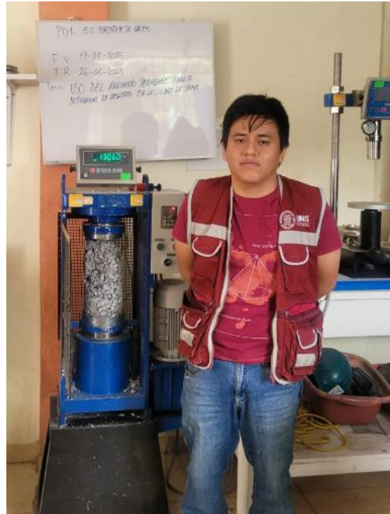
Foto 51. Probeta 1 – 15% de vacío
