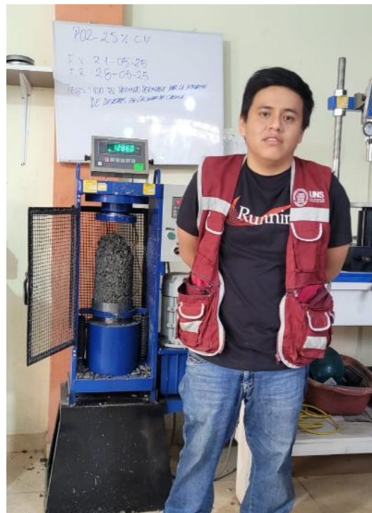
Foto 56. Probeta 2 – 25% de vacío
