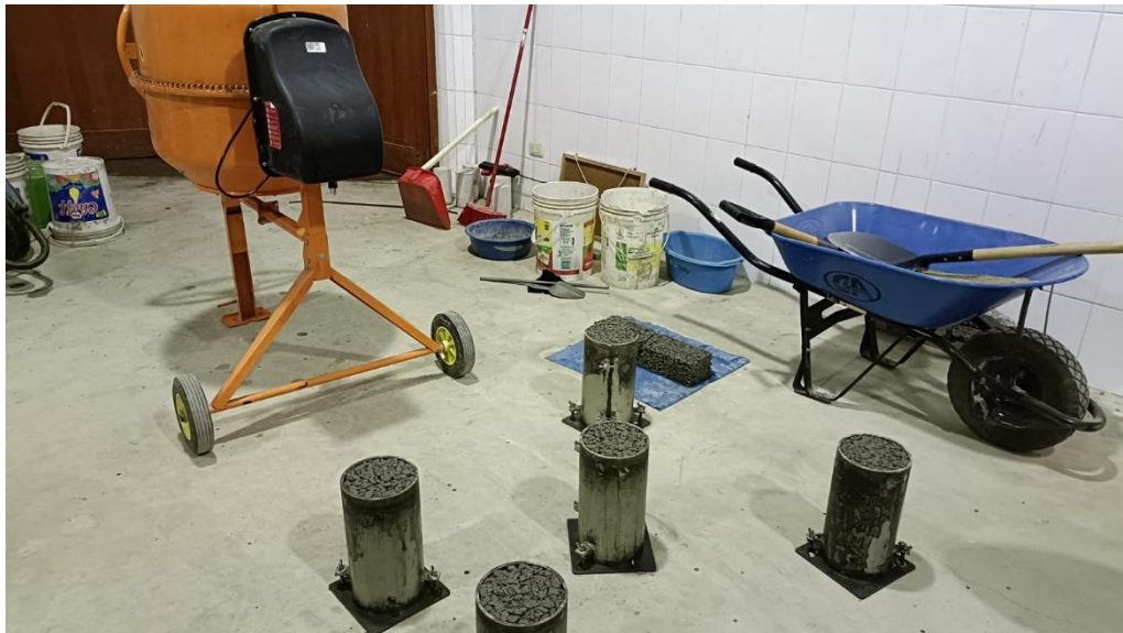
Foto 50. Probetas con 35% de porcentaje de vacío
