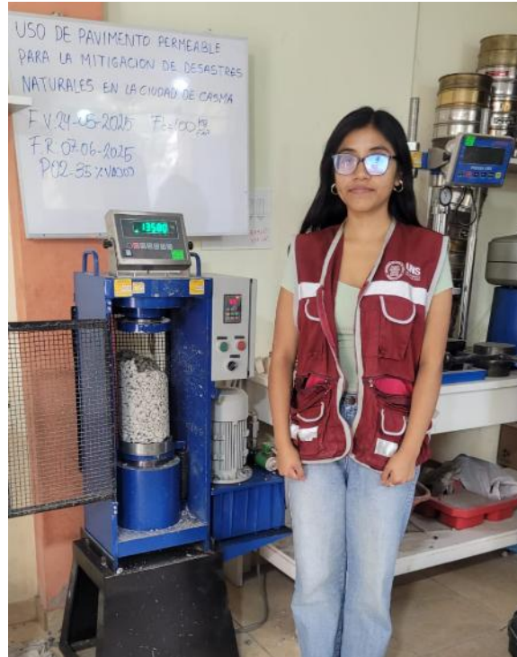
Foto 70. Probeta 2 – 35% de vacío
