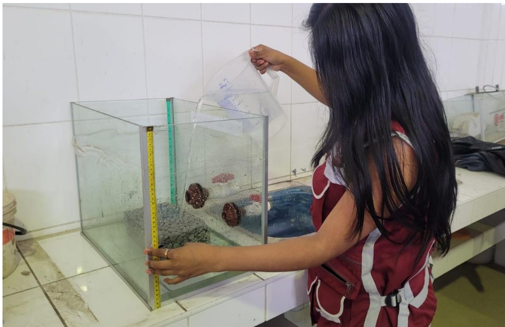
Foto 84. Prueba de infiltración con concreto 15% vacío
