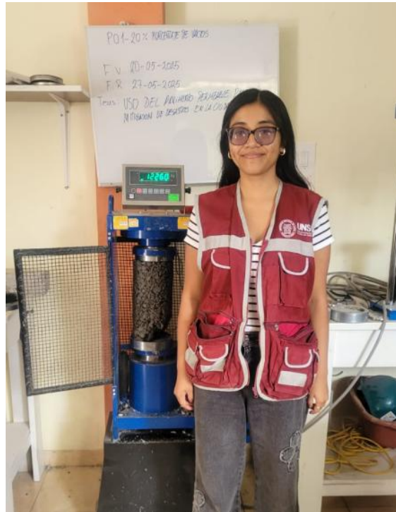
Foto 53. Probeta 1 – 20% de vacío
