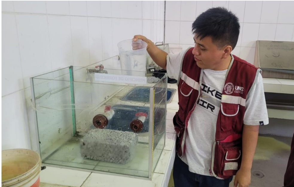
Foto 87. Prueba de infiltración con concreto 30% vacío
