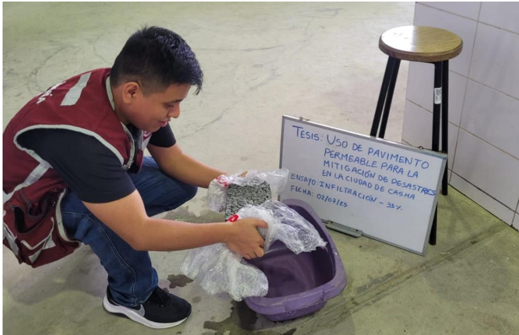
Foto 83. Prueba de escorrentía superficial con concreto 35% vacío
