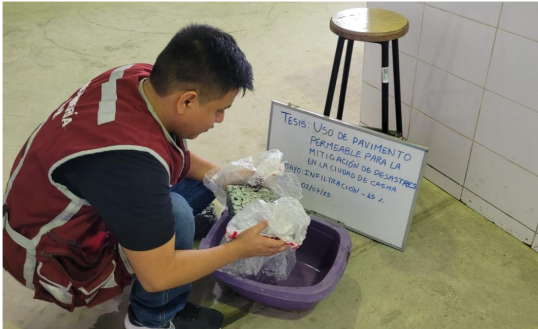
Foto 81. Prueba de escorrentía superficial con concreto 25% vacío
