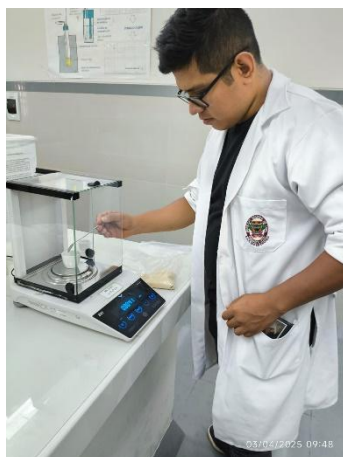
Figura 35. Pesado de los crisoles y la muestra
