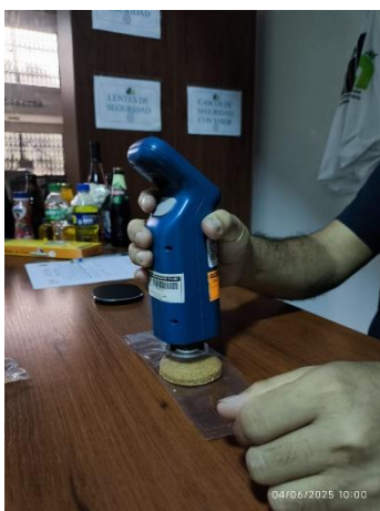
Figura 54. Medición del color de la muestra.
