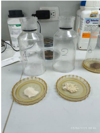
Figura 42. Pesado de 1g de muestra desgrasada y adición de 50 ml de buffer fosfato
