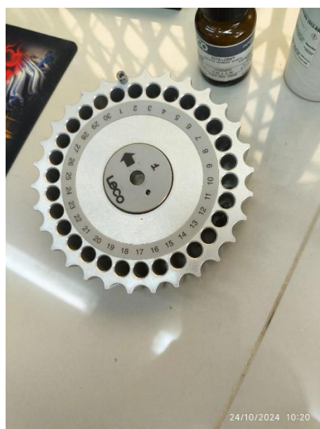
Figura 50. Colocación del capachito con la muestra.
