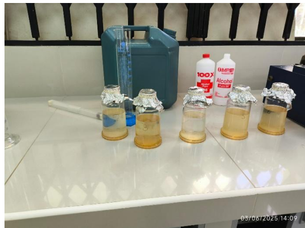
Figura 45. Adición de alcohol y reposo por 1 hr.
