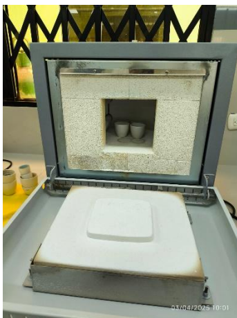
Figura 36. Incineración de las muestras en mufla
