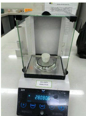
Figura 37. Pesado del crisol más cenizas
