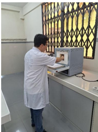
Figura 48. Las muestras secas fueron incineradas a 550°C por 4 hr.
