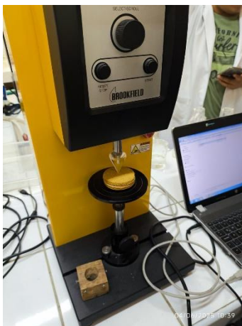
Figura 51. Medición de dureza
