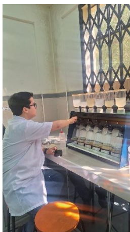
Figura 47. Proceso de filtración aplicando presión y succión.
