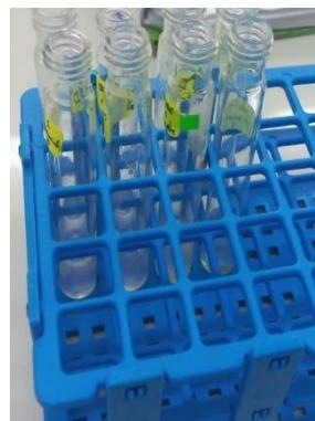
Añadir 5 mL de solución saturada de NaCl, cubrir con una capa de N<sub>2</sub>, agitar, enfriar a Temp ambiente.
