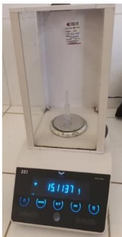
Pesado del picnómetro vacío
