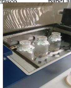
Colocar frascos a baño maría T(°C): 60, t(min): 30, luego enfriar con agua destilada y medir Ph (4 - 4.6) con HCL 0.325N
