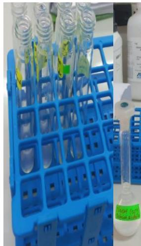
Añadir 1.5 mL de solución NaOH 0.5 N, cubrir con una capa de N<sub>2</sub>
