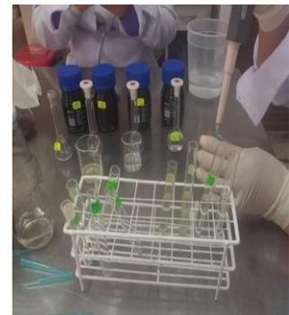
Agregar 6 ml de solución (5 ml de la muestra con isooctano y 1 ml de reactivo anisidina con ácido acético glacial)
