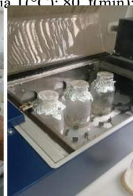
Colocar frascos a baño maría T(°C): 60, t(min): 30, junto con alcohol (usado para FDT)
