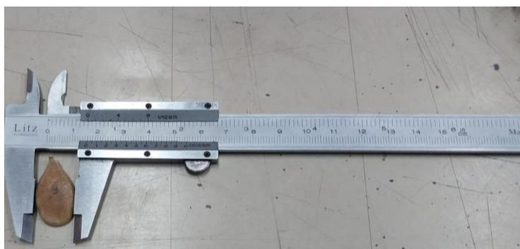
*Figura 30. Medición del diámetro de la semilla de zapallo (diámetro mayor, diámetro medio y diámetro menor).*
