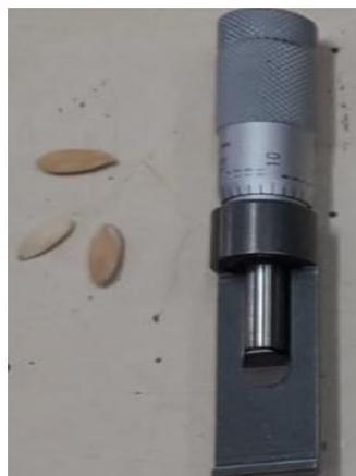
*Figura 31. Medición del diámetro de la semilla de melón (Diámetro menor).*
