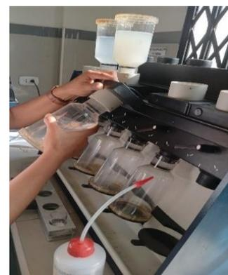
Enfriar con agua destilada los frascos, sin dejar restos en las paredes y medir pH y ajustar con NaOH 0.275N
