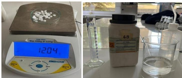
**Figura 06.** Preparación de solución de Hidróxido de sodio NaOH al 8%.
