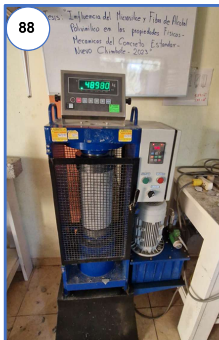
Fotografía N° 88: Rotura de muestra adicionando 1.0 % fibra de PVA y 5.0% de microsílíce a los 28 días.
