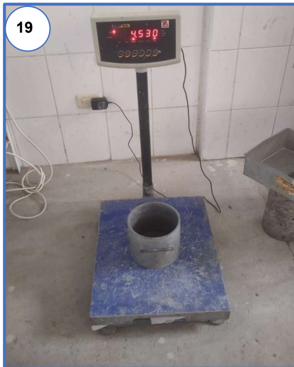
Fotografía N° 19: Pesado del recipiente para realizar el ensayo de peso unitario suelto y compactado del agregado fino y agregado grueso.
