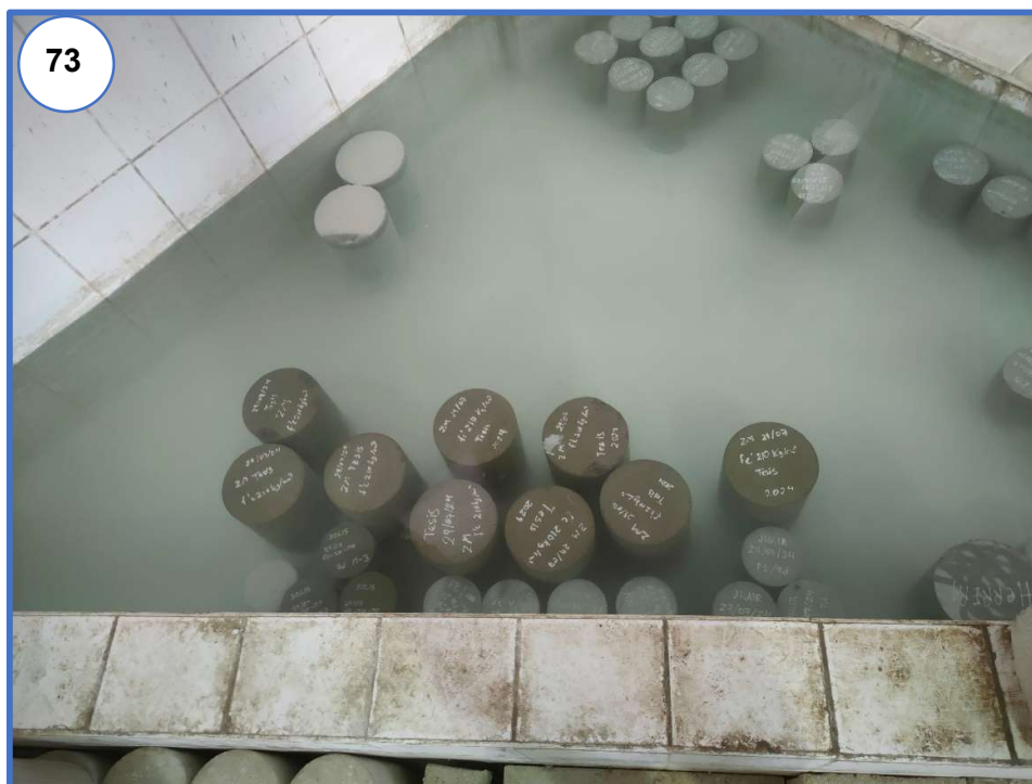
Fotografía N° 73: Curado de las probetas codificadas correctamente para su identificación en los ensayos de rotura.
