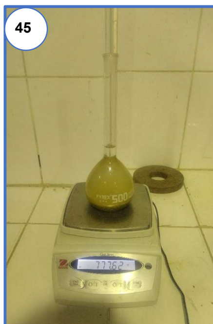
Fotografía N° 45: Muestra el pesaje del material del agregado fino dentro del frasco volumétrico luego de rellenar con más agua destilada luego de haber eliminado las burbujas
