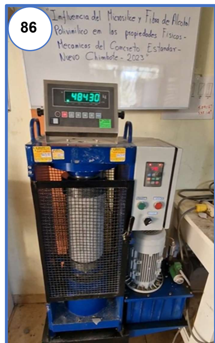
Fotografía N° 86: Rotura de muestra adicionando 0.5% fibra de PVA y 10.0% de microsilíce a los 28 días.
