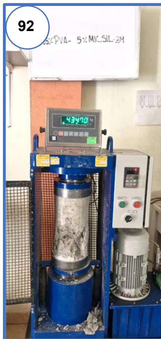
Fotografía N° 92: Rotura de muestra adicionando 1.5% fibra de PVA y 5.0% de microsíllice a los 28 días.
