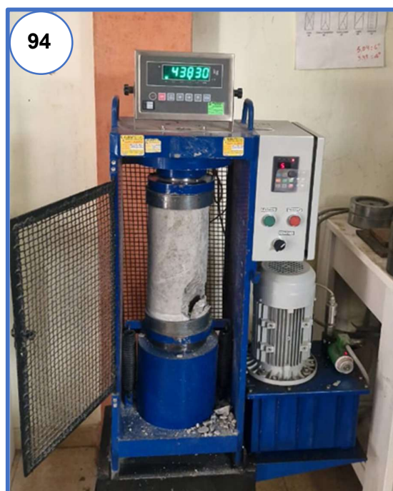
Fotografía N° 94: Rotura de muestra adicionando 1.5% fibra de PVA y 15.0% de microsílíce a los 28 días.
