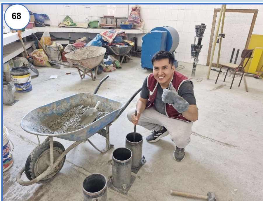
Fotografía N° 68: Se realizó la compactación en 3 capas con 25 golpes de manera uniforme sobre cada una de ellas, se utilizó una varilla lisa de 5/8", acto seguido se golpeó suavemente los lados del molde con el martillo de goma para liberar el aire atrapado y asentar el concreto.
