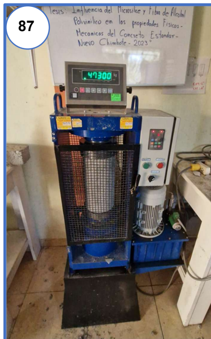
Fotografía N° 87: Rotura de muestra adicionando 0.5% fibra de PVA y 15.0% de microsílíce a los 28 días.
