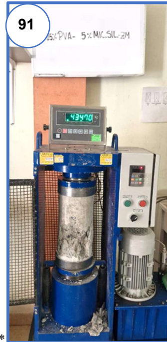
Fotografía N° 91: Rotura de muestra adicionando 1.0 % fibra de PVA y 15.0% de microsíllice a los 28 días.
