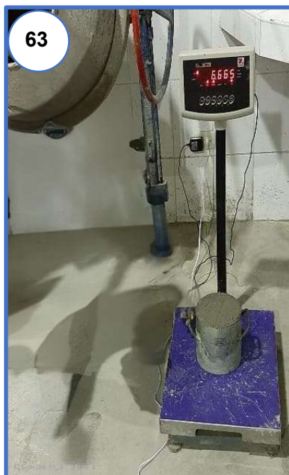
Fotografía N° 63: Se realizó también la medición del peso unitario del concreto fresco
