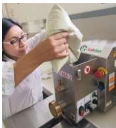
Figura 44. Adición al equipo de pastas la mezcla de harinas
