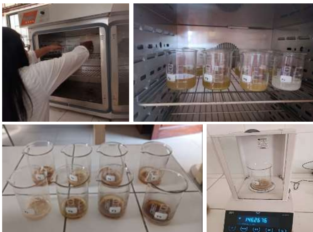
Figura 51. Determinación de la Pérdida de sólidos
