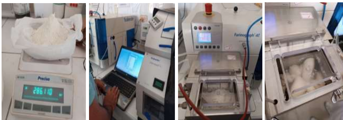
Figura 38. Determinación del farinograma de la harina de trigo
