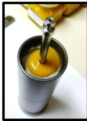
d) Se utilizo al equipo reómetro digital, el cual es controlado por medio del software RHEO3000, permitiendo determinar los parámetros de temperatura ( $^{\circ}\text{C}$ ), esfuerzo cortante ( $\text{Pa}\cdot\text{s}$ ) y velocidad de deformación ( $\text{s}^{-1}$ ), esperamos que se estabilice el equipo, luego revisamos los resultados y el gráfico que nos brindó el software
