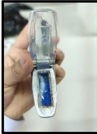
b) Se tomo lectura a los grados brix mediante el refractómetro digital
