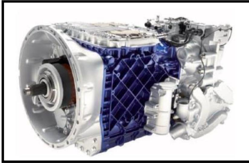
*Nota.* La imagen muestra la caja de cambio empleada por los buses Volvo B380R 4X2 con transmisión automatizada. Fuente: Autoline Perú (2018).
