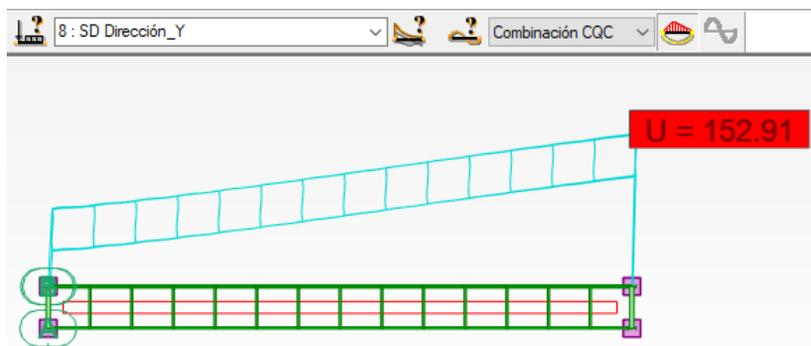
*Nota:* Torsión del Pipe rack en la dirección “y”. Fuente (Propio)
