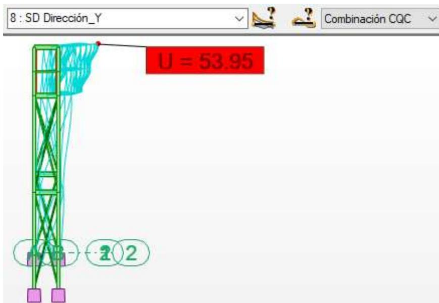
*Nota:* Deformación de 54 mm causado por sismo en la dirección "y". Fuente (Propio)
