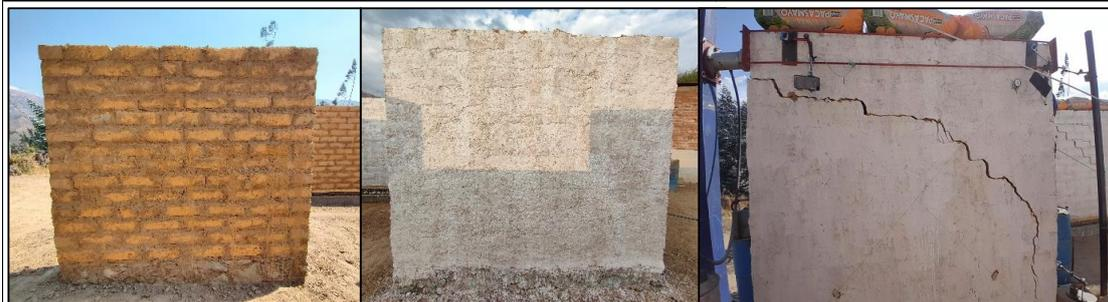
*Nota.* Durante el ensayo, el muro presentó dos modos de falla: inicialmente, se observó un agrietamiento diagonal (AD) en la parte superior a lo largo de las juntas, seguido de grietas verticales en la parte inferior debido al aplastamiento (AP). La abertura máxima de la grieta horizontal fue de 8.03 mm, mientras que la de la grieta vertical alcanzó 22.34 mm.
