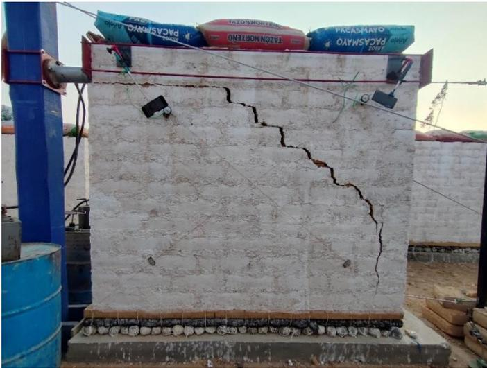
*Nota.* Se observa el modo de falla del tratamiento T<sub>2</sub> después del ensayo.
