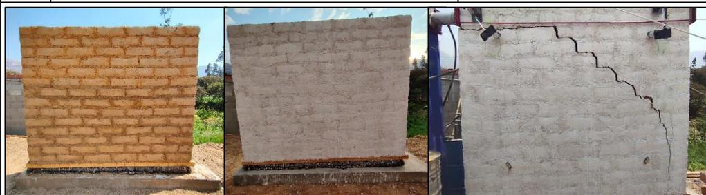
*Nota.* Durante el ensayo, el muro presentó tres modos de falla: primero, falló por deslizamiento (D) en la segunda fila horizontal superior; luego se produjo un agrietamiento diagonal (AD) a lo largo de las juntas, y, finalmente, aparecieron grietas verticales en la parte inferior del muro debido al aplastamiento (AP). La abertura máxima de la grieta horizontal fue de 7.97 mm, mientras que la de la grieta vertical alcanzó 22.48 mm.
