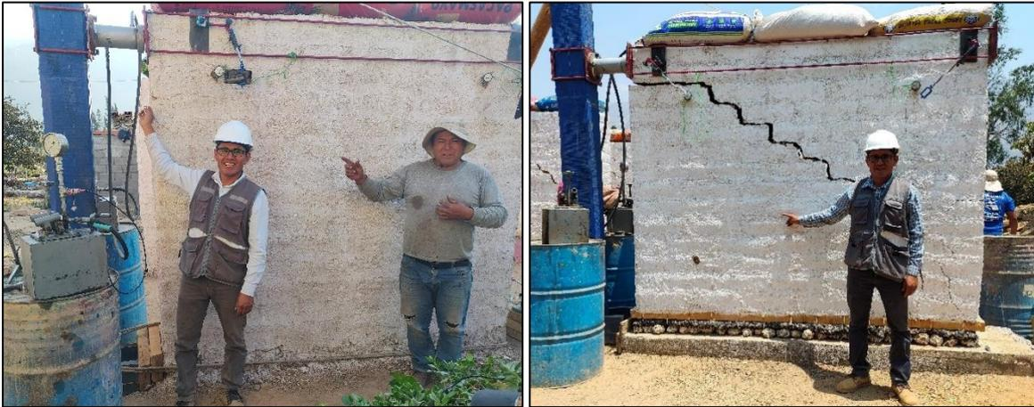
*Nota.* Se muestra los equipos utilizados para el ensayo monotónico y el muro después del ensayo.
