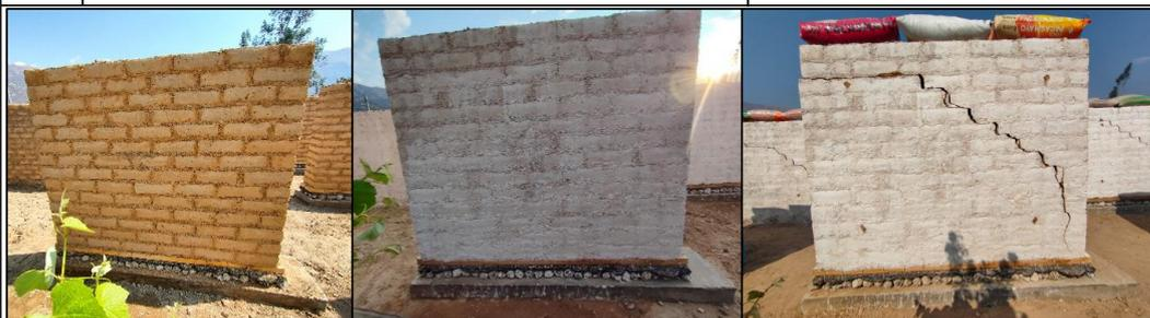
*Nota.* Durante el ensayo, el muro presentó tres modos de falla: inicialmente, se produjo un deslizamiento (D) en la segunda fila horizontal superior del muro; posteriormente, se observó un agrietamiento diagonal (AD) a lo largo de las juntas, y, finalmente, aparecieron grietas verticales en la parte inferior del muro debido al aplastamiento (AP). La abertura máxima de la grieta horizontal fue de 6.82 mm, mientras que la de la grieta vertical alcanzó 24.71 mm.
