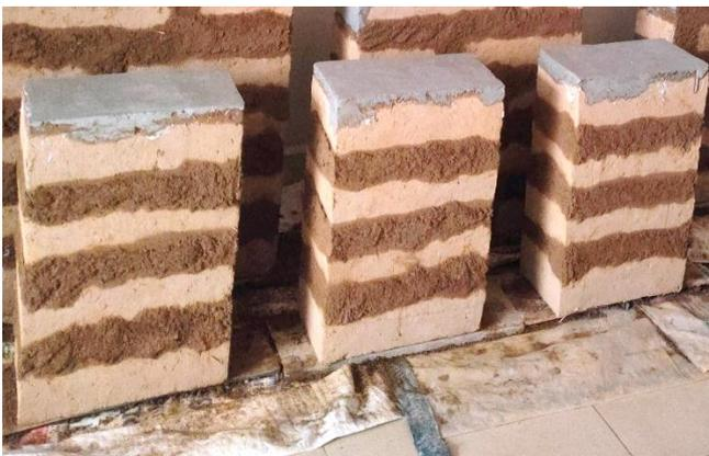
*Nota.* Se observa que las caras de asentado se mojaron para el colocado del mortero; también se observa el refrentado con yeso de dos caras del prisma.
