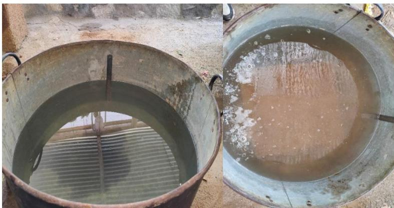
*Nota.* En la fotografía se observa el recipiente contenido de agua y dispuesto con una regla metálica y el adobe sumergido durante 24 horas.
