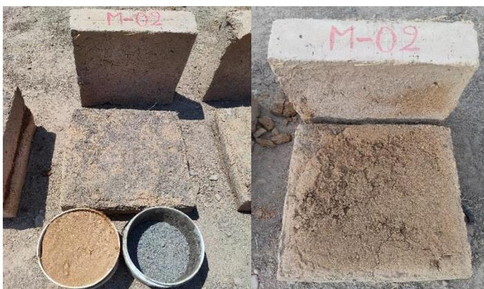
*Nota.* Se observa como el mortero ha presentado fisuras en la muestra 02 con dosificación 1:0.5 (suelo : arena gruesa) después de 48 horas de secado.
