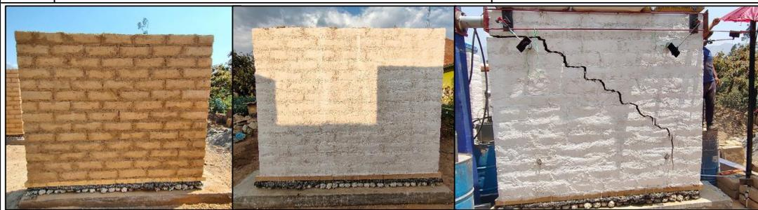
*Nota.* Durante el ensayo, el muro presentó dos modos de falla: inicialmente, se observó un agrietamiento diagonal (AD) en la parte superior a lo largo de las juntas, seguido de grietas verticales en la parte inferior del muro debido al aplastamiento (AP). La abertura máxima de la grieta horizontal fue de 5.75 mm, mientras que la de la grieta vertical alcanzó 24.97 mm.
