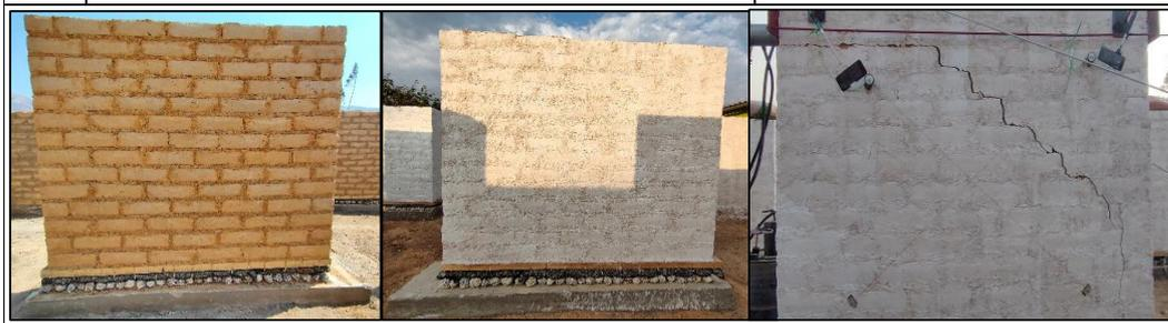
*Nota.* Durante el ensayo, el muro presentó tres modos de falla: inicialmente, falló por deslizamiento (D) en la segunda fila horizontal superior del muro; luego, se observó un agrietamiento diagonal (AD) a lo largo de las juntas, y, finalmente, se presentaron grietas verticales en la parte inferior del muro debido al aplastamiento (AP). La abertura máxima de la grieta horizontal fue de 6.72 mm, mientras que la de la grieta vertical alcanzó 26.59 mm.
