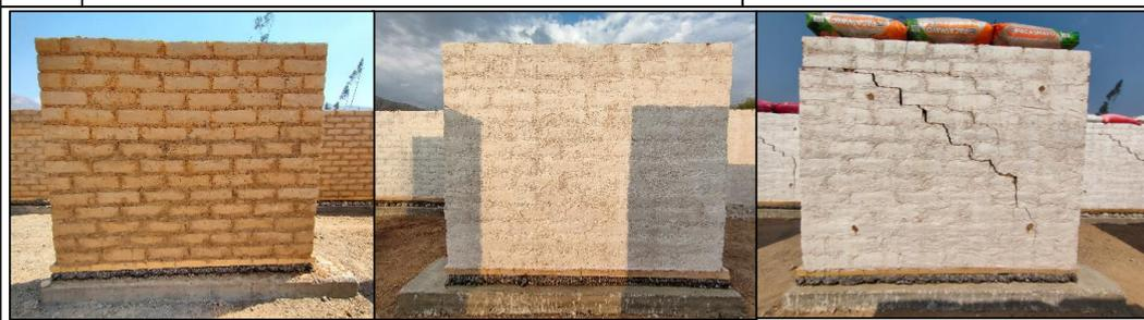
*Nota.* Durante el ensayo, el muro presentó tres modos de falla: primero, se produjo un deslizamiento (D) en la segunda fila horizontal superior del muro; posteriormente, se observó un agrietamiento diagonal (AD) a lo largo de las juntas, y, finalmente, aparecieron grietas verticales en la parte inferior del muro debido al aplastamiento (AP). La abertura máxima de la grieta horizontal fue de 5.63 mm, mientras que la de la grieta vertical alcanzó 19.31 mm.
