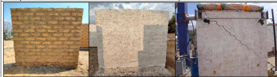
*Nota.* Durante el ensayo, el muro presentó tres modos de falla: inicialmente falló por deslizamiento (D) en la segunda fila horizontal superior, seguido de un agrietamiento diagonal (AD) que afectó tanto las juntas como los adobes. Finalmente, se observaron grietas verticales en la parte inferior del muro debido al aplastamiento (AP). La abertura máxima de la grieta horizontal fue de 6.99 mm, mientras que la de la grieta vertical alcanzó 20.64 mm.
