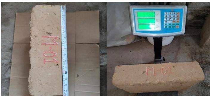
*Nota.* Se observa la medición de los lados del adobe y el pesado en una balanza eléctrica con una presión de 0.01 kg.
