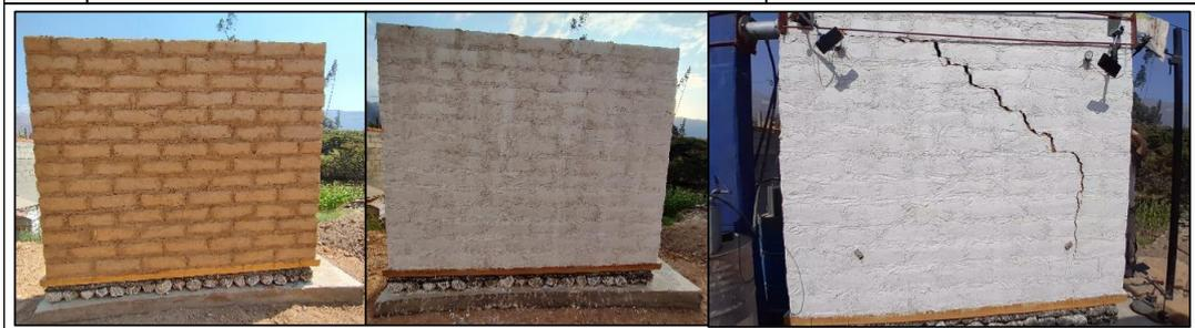
*Nota.* Durante el ensayo, el muro presentó tres modos de falla: primero, se produjo un deslizamiento (D) en la segunda fila horizontal superior del muro; posteriormente, se observó un agrietamiento diagonal (AD) a lo largo de las juntas, y, finalmente, se presentaron grietas verticales en la parte inferior del muro debido al aplastamiento (AP). La abertura máxima de la grieta horizontal fue de 6.25 mm, mientras que la de la grieta vertical alcanzó 23.68 mm.
