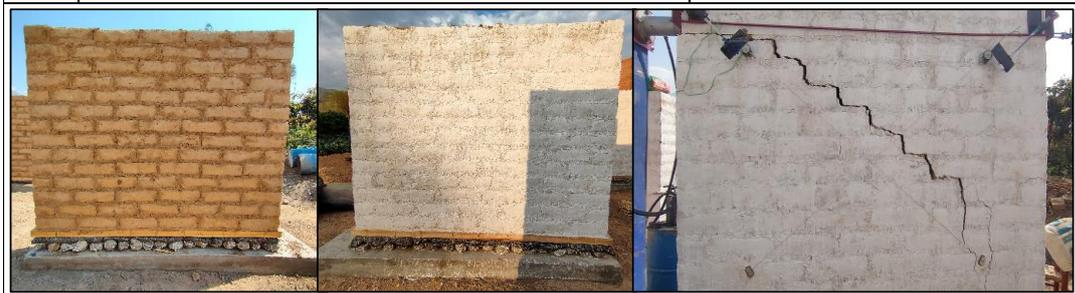
*Nota.* Durante el ensayo, el muro presentó dos modos de falla: primero, se observó un agrietamiento diagonal (AD) en la parte superior a lo largo de las juntas, seguido de la aparición de grietas verticales en la parte inferior del muro debido al aplastamiento (AP). La abertura máxima de la grieta horizontal fue de 6.42 mm, mientras que la de la grieta vertical alcanzó 17.79 mm.
