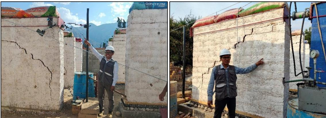
*Nota.* Modos de falla en los muros de adobe debido a la carga horizontal aplicado.
