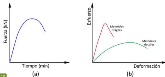
Nota. En la figura (a) se observa la curva tiempo vs fuerza, y en (b) se visualiza la curva desplazamiento vs fuerza. Adaptado de Ayala et al. (2021) y Mora, W. (2022), respectivamente.
