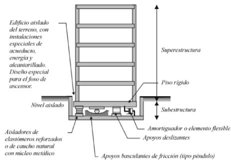
Nota. Se observa aislamientos en la base de una edificación. Tomado de *Sistema de control de respuesta sísmica en edificaciones* (p. 110), por Oviedo y Duque, 2006.
