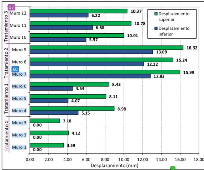
Nota. Se presentan los valores de los desplazamientos horizontales registrados en la parte superior e inferior de los muros como resultado de la aplicación de la carga lateral máxima.
