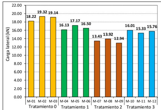
Nota. En la figura se observa que los muros con sobrecimiento tradicional soportaron mayor carga lateral.
