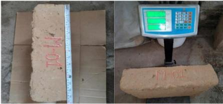
*Nota.* Se observa la medición de los lados del adobe y el pesado en una balanza eléctrica con una presión de 0.01 kg.
