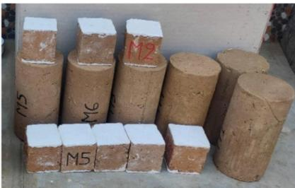
*Nota.* Se observan las muestras de cubos refrentado con yeso con la finalidad de uniformizar la cara de apoyo donde se aplicaron las cargas.
