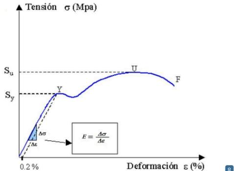
Nota. Se muestra que a partir del diagrama se puede determinar el módulo de elasticidad (E) del material. Adaptado de Universitat de Jaume I (2022).
