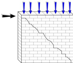
*Nota.* Se muestra el agrietamiento diagonal del muro cuando es sometido a un solo sentido de carga lateral. Reproducido de Arencibia, 2011.
