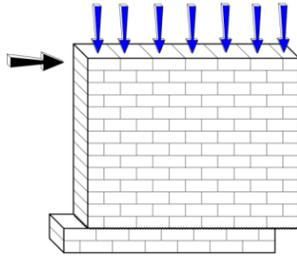
*Nota.* Se muestra el deslizamiento del muro en la junta inferior. Reproducido de Arencibia, 2011.
