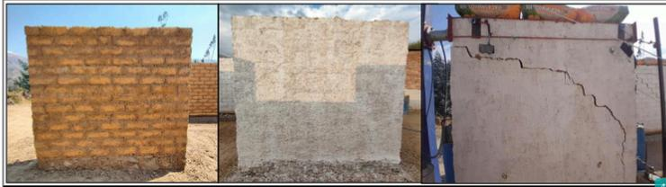
*Nota.* Durante el ensayo, el muro presentó dos modos de falla: inicialmente, se observó un **agrietamiento diagonal (AD) en la parte superior** a lo largo de las juntas, seguido de grietas verticales en la parte inferior debido al aplastamiento (AP). La abertura máxima de la grieta horizontal fue de 8.03 mm, mientras que la de la grieta vertical alcanzó 22.34 mm.
