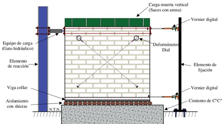
*Nota.* Se visualiza los equipos de medición instalados en el muro experimental ensayo bajo carga monotónica.
