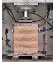
**Anexo O. Datos del ensayo de tracción indirecta en muretes**
