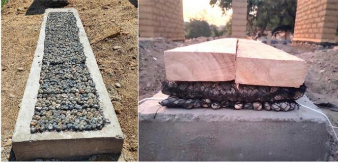
*Nota.* Se observa piedras de 1" rellenas en malla de pecar, y las tres capas que conforman el sobrecimiento del tratamiento  $T_1$ .
