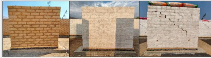
*Nota.* Durante el ensayo, el muro presentó tres modos de falla: primero, se produjo un deslizamiento (D) en la segunda fila horizontal superior del muro; posteriormente, se observó un agrietamiento diagonal (AD) a lo largo de las juntas, y, finalmente, aparecieron grietas verticales en la parte inferior del muro debido al aplastamiento (AP). La abertura máxima de la grieta horizontal fue de 5.63 mm, mientras que la de la grieta vertical alcanzó 19.31 mm.
