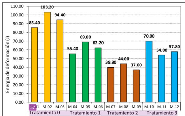
Nota. En la figura se observa que los muros con sobrecimiento de shicras y piedras de 3" almacenaron una menor cantidad de energía de deformación debido a la carga lateral. Los valores de la energía de deformación (módulo de tenacidad) fueron calculados a partir de la gráfica esfuerzo cortante vs deformación angular.
