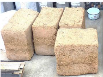
*Nota.* Se observa especímenes conformado por dos adobes y con junta de barro.
