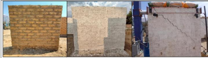
*Nota.* Durante el ensayo, el muro presentó tres modos de falla: inicialmente falló por deslizamiento (D) en la segunda fila horizontal superior, seguido de un grieteo diagonal (AD) que afectó tanto las juntas como los adobes. Finalmente, se observaron grietas verticales en la parte inferior del muro debido al aplastamiento (AP). La abertura máxima de la grieta horizontal fue de 6.99 mm, mientras que la de la grieta vertical alcanzó 20.64 mm.
