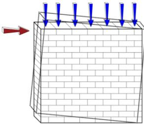
*Nota.* Se muestra el volteo del muro al aplicar una fuerza lateral. Reproducido de Preciado, 2016.
