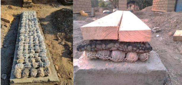
*Nota.* Se observa piedras de 3" rellenas en shicras, y las tres capas que conforman el sobrecimiento del tratamiento  $T_2$ .
