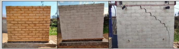
*Nota.* Durante el ensayo, el muro presentó tres modos de falla: primero, falló por deslizamiento (D) en la segunda fila horizontal superior; luego produjo un agrietamiento diagonal (AD) a lo largo de las juntas, y, finalmente, aparecieron grietas verticales en la parte inferior del muro debido al aplastamiento (AP). La abertura máxima de la grieta horizontal fue de 7.97 mm, mientras que la de la grieta vertical alcanzó 22.48 mm.
