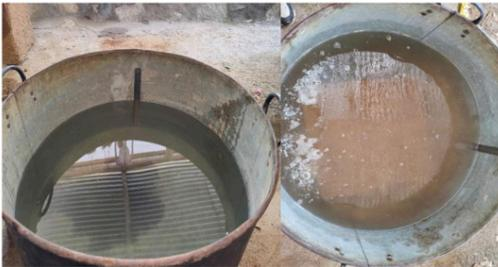
*Nota.* En la fotografía se observa el recipiente contenido de agua y dispuesto con una regla metálica y el adobe sumergido durante 24 horas.
