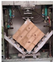
**Anexo P. Resultados del ensayo de muros bajo carga lateral***Resultados del ensayo de muros bajo carga lateral*
