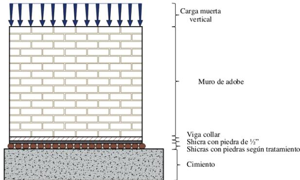
*Nota.* El cimiento, el muro y la carga vertical estática fueron iguales para todos los muros.
