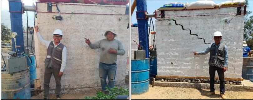
*Nota.* Se muestra los equipos utilizados para el ensayo monotónico y el muro después del ensayo.
