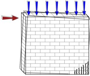
*Nota.* Se muestra el aplastamiento de las unidades de albañilería en el pie del muro. Reproducido de Preciado, 2016 y Arencibia, 2011.
