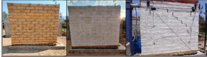
*Nota.* Durante el ensayo, el muro presentó tres modos de falla: inicialmente, falló por deslizamiento (D) en la segunda fila horizontal superior; posteriormente, se produjo un agrietamiento diagonal (AD) a lo largo de las juntas, y finalmente, aparecieron grietas verticales en la parte inferior del muro debido al aplastamiento (AP). La abertura máxima de la grieta horizontal fue de 6.80 mm, mientras que la de la grieta vertical alcanzó 22.54 mm.
