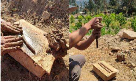
*Nota.* Se observa la elaboración de la muestra cilíndrica y como se deja colgar la cinta de barro.
