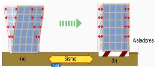
Nota. En (a) se observa la respuesta de una estructura convencional ante un sismo, mientras que en (b) se presenta la respuesta de una estructura con aislamiento sísmico en la base. Adaptado de *Utilización de disipadores de energía en edificaciones de baja altura* (p. 11), por Tovar, 2008.
