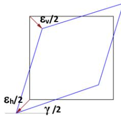
*Nota.* Se observa la deformación que adquiere el muro al ser sometido a compresión diagonal. Adaptado de *Diseño y construcción de estructuras sismorresistentes de albañilería*, por San Bartolomé et al. (2018).
