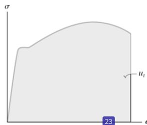
*Nota.* Del gráfico observado, el módulo de tenacidad corresponde al área total bajo la curva. Tomado de *Mecánica de materiales*, por Hibbeler (2017).
