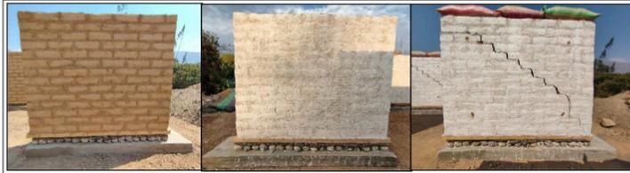
*Nota.* Durante el ensayo, el muro presentó dos modos de falla: inicialmente, se observó un agrietamiento diagonal (AD) en la parte superior a lo largo de las juntas, seguido de la aparición de grietas verticales en la parte inferior del muro debido al aplastamiento (AP). La abertura máxima de la grieta horizontal fue de 6.72 mm, mientras que la de la grieta vertical alcanzó 19.76 mm.
