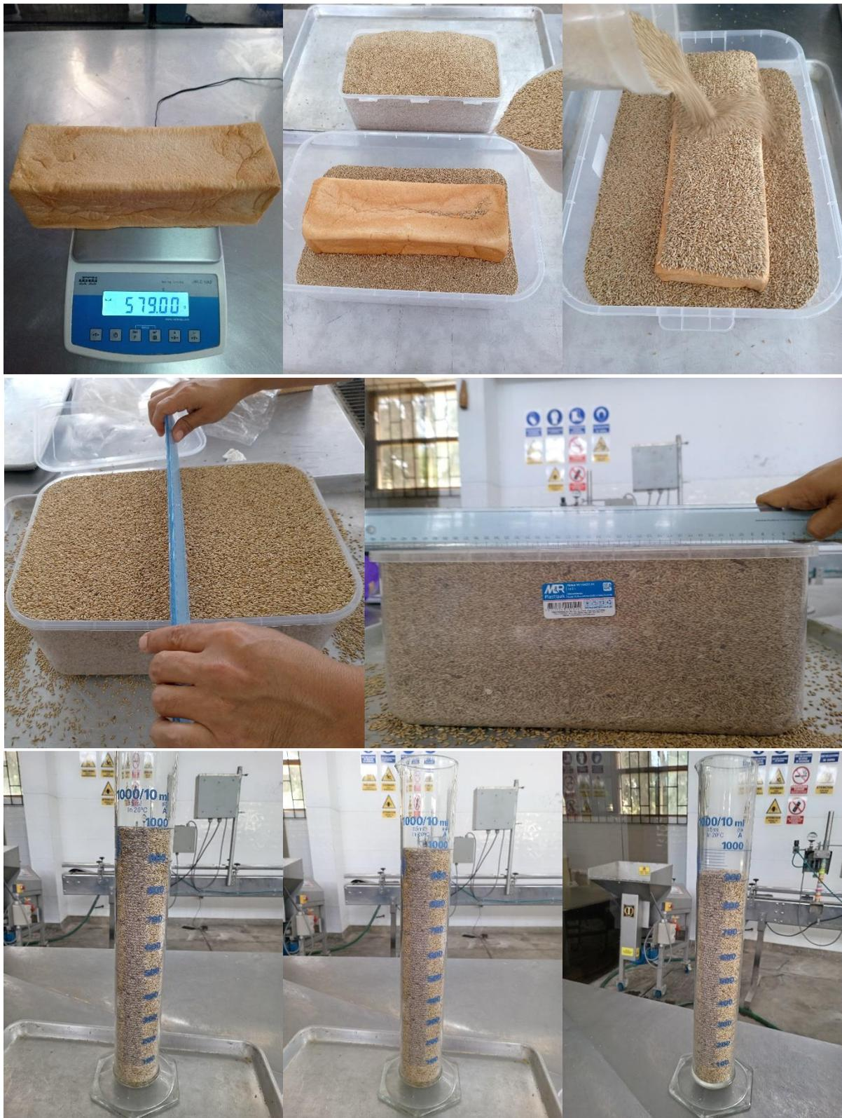
Determinación del volumen específico del pan de molde.
