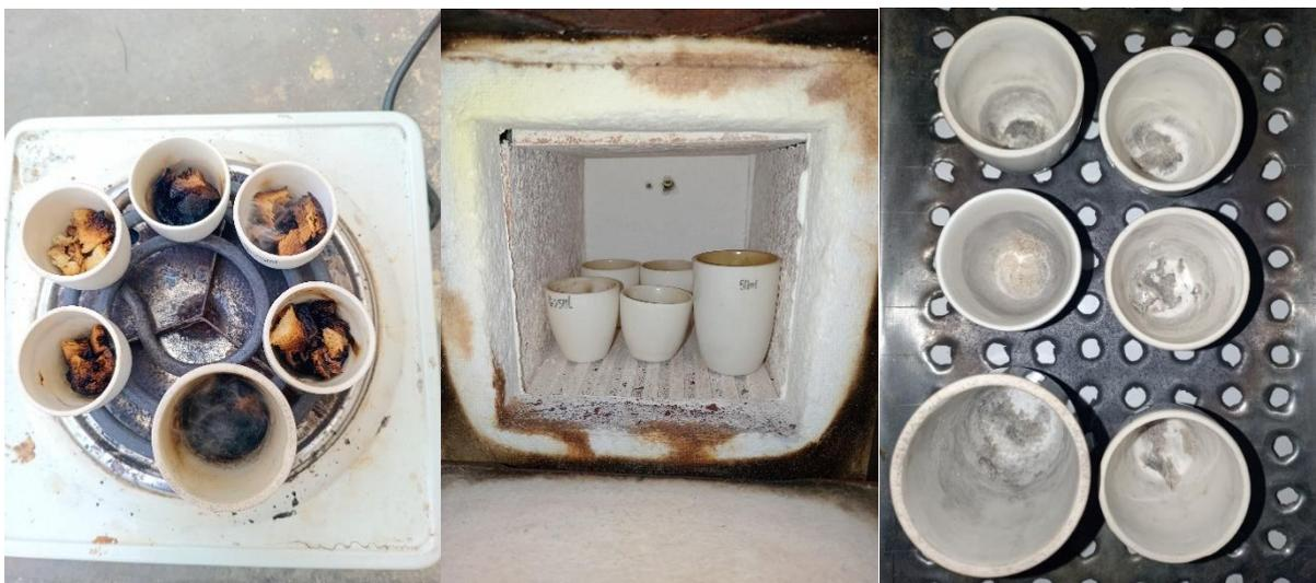
Determinación del porcentaje de cenizas del pan de molde.
