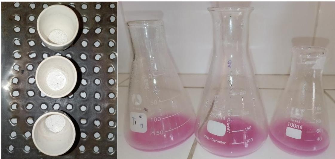
Determinación del porcentaje de cenizas y de la alcalinidad de las cenizas de la pectina.
