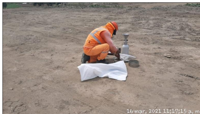
Foto 03: Análisis de compactación para cierre de DME-Reque
