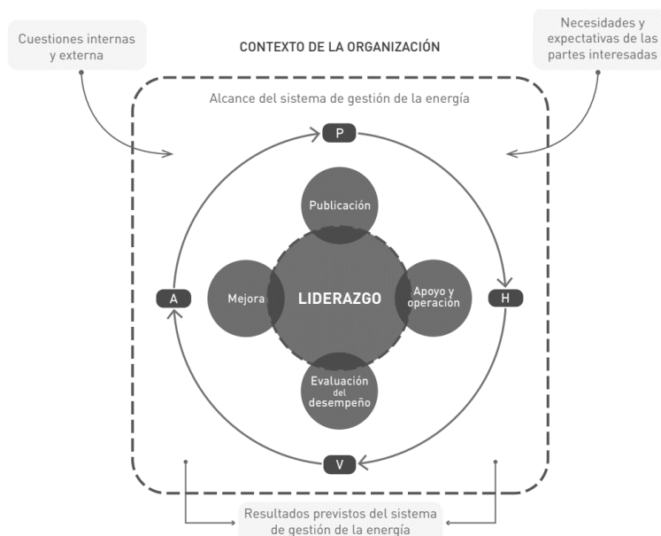
Figura 1. Modelo del Sistema de Gestión de la energía según ISO 50001:2018
