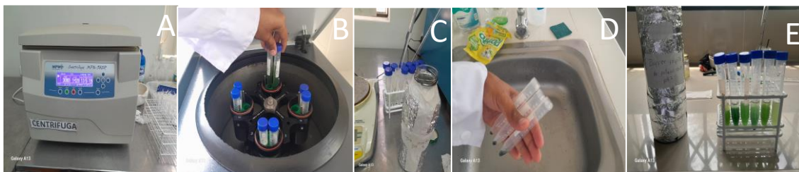
Anexo 27. Proceso de determinación de pigmentos (ficoeritrina, ficocianina y aloficocianina). (A) Espectrofotómetro. (B) Centrifugar los tubos con suspensión de Spirulina . (C) Adicionar agua acidulada a pH 4. (D) Eliminar el sobrenadante después de centrifugar los tubos. (E) Añadir solución amortiguadora de fosfato de potasio a los tubos.
