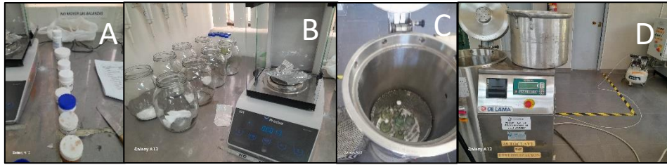
Anexo 24. Proceso de preparación del medio Zarrouk. (A) Pesado de reactivos y su posterior mezcla en las cámaras microalgales. (B) Listado de los reactivos: bicarbonato de sodio, fosfato dipotásico, nitrato de sodio, sulfato de potasio, cloruro de sodio, sulfato de magnesio heptahidratado, cloruro de calcio, sulfato ferroso heptahidratado y EDTA. (C y D) Esterilizado del medio en autoclave a 220 °C por 20 minutos.
