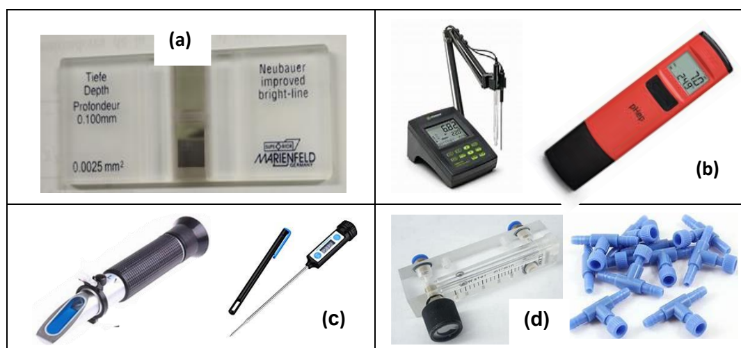
Figura A.2. Instrumentos de laboratorio, varios: (a) cámara Neubauer; (b) pH-metro de mesa y portátil; (c) refractómetro de salinidad y termómetro digital; (d) flujómetro y válvulas.
