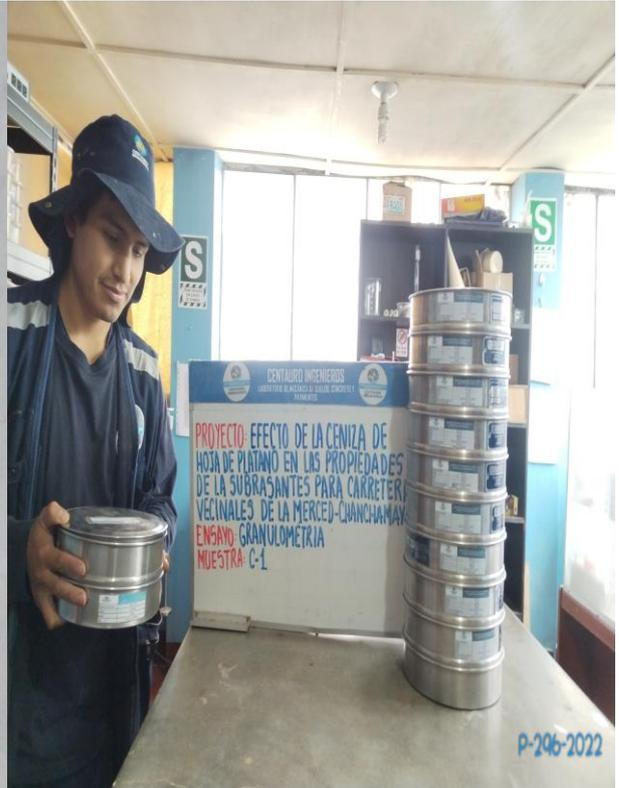
Figura 20: Análisis granulométrico del suelo
