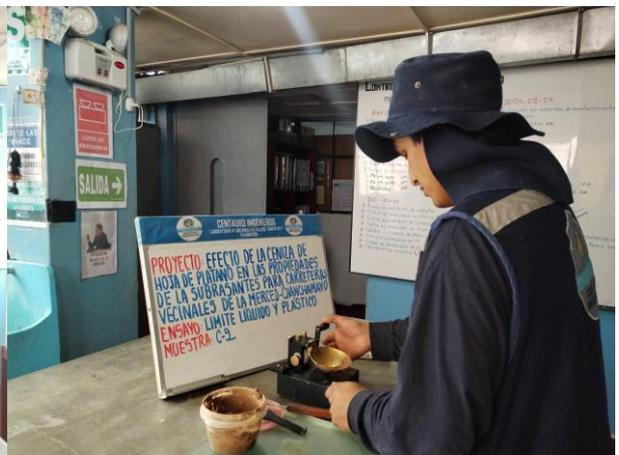
Figura 22: Ensayo del límite líquido en la copa de Casagrande
