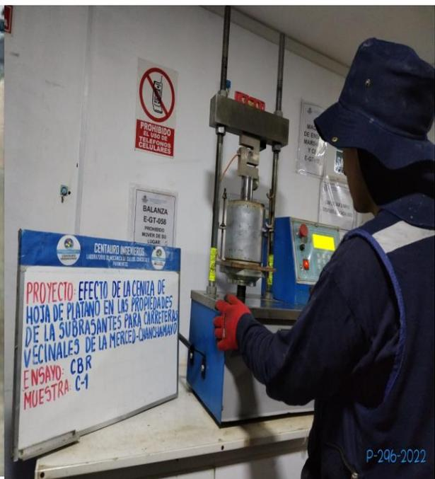
Figura 26: Ensayo en la prensa de CBR
