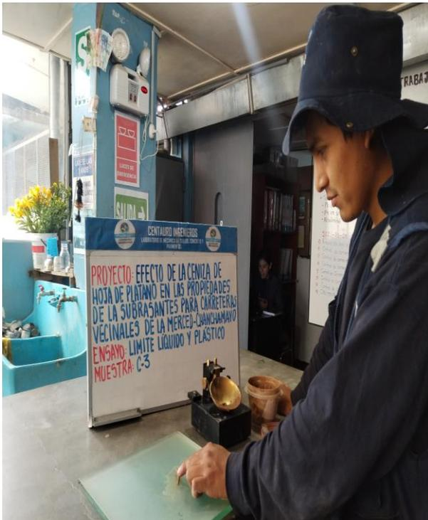
Figura 23: Ensayo de limite plástico
