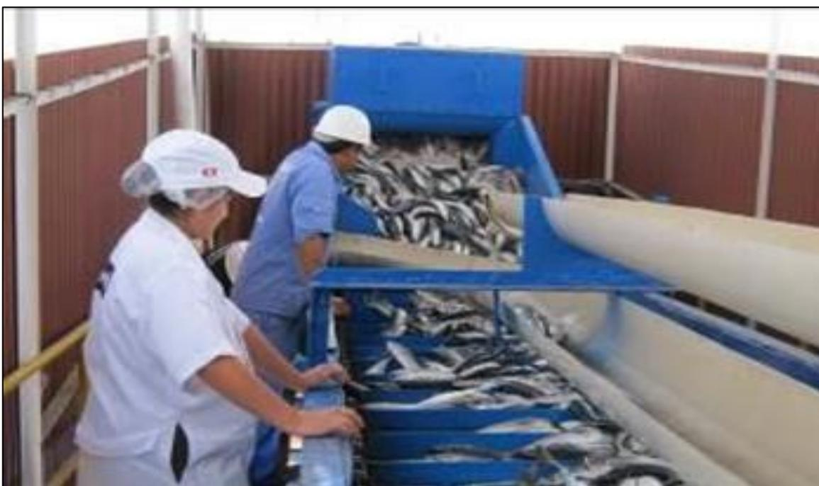
Figura 25: Sistema de descarga con faja
