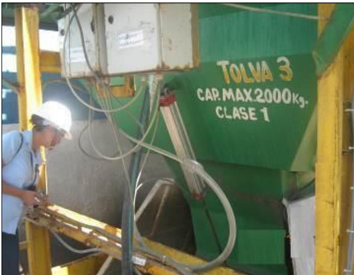
Figura 15: Fiscalizador verificando apertura/cierre de la compuerta de la tolva
