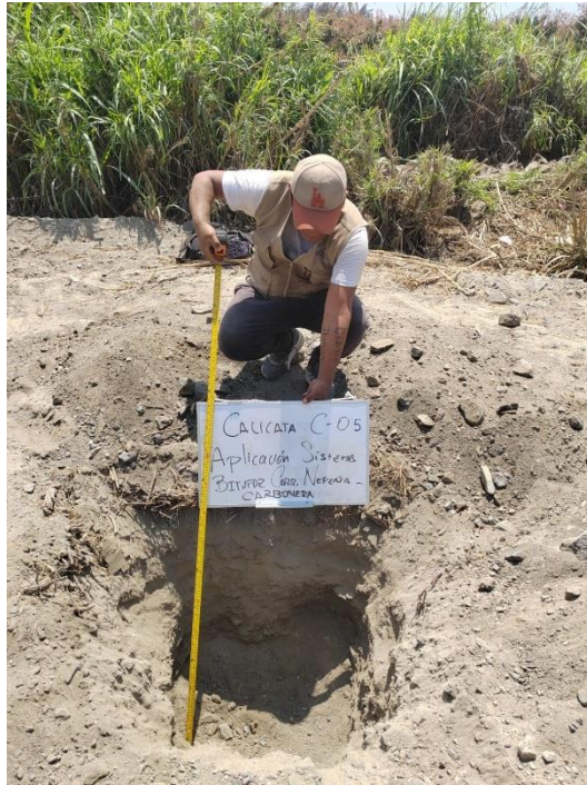
Foto N° 05: Excavación de la calicata N° 05
