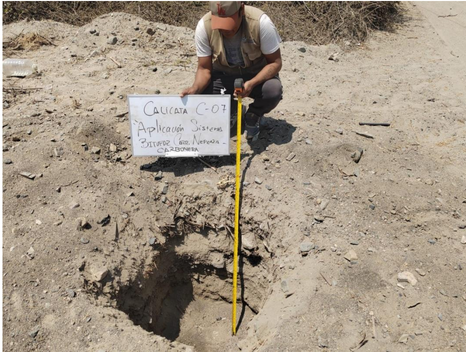
Foto N° 07: Excavación de la calicata N° 07
