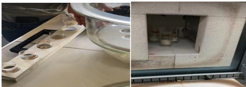
**Anexo 39.** Retiro de los crisoles y colocado a la mufla.
