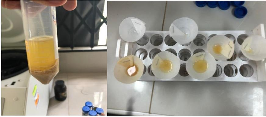
**Anexo 47.** Centrifugación y filtración de la muestra.
