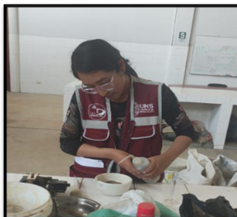
Fotografía 53 Determinación del límite líquido de las respectivas muestras de la zona en estudio con las combinaciones de ceniza de mazorca de maíz y cal
