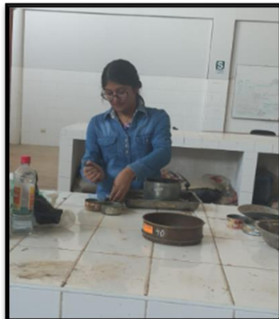
Fotografía 62 Enrasado y Toma de tres muestras de la mezcla compactada para obtener mediante el promedio el óptimo contenido de humedad de cada Proctor.
