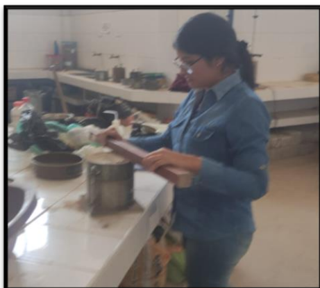
Fotografía 61 Enrasado y pesaje del molde con mezcla de suelo y ceniza de mazorca de maíz con cal.
