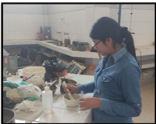
Fotografía 53 Determinación del límite líquido de las respectivas muestras de la zona en estudio con las combinaciones de ceniza de mazorca de maíz y cal
