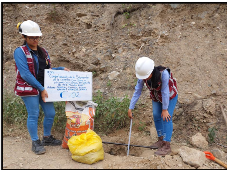
Fotografía 12 Excavación de la calicata C-02 en la Carretera San Blas- Macate correspondiente al tramo 0+000km – 1+500km
