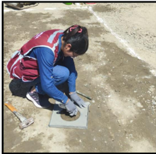
Fotografía 37 El suelo obtenido se coloca en una bolsa plástica para mantener su humedad, para que posteriormente sea llevado al laboratorio y se determina su contenido de humedad
