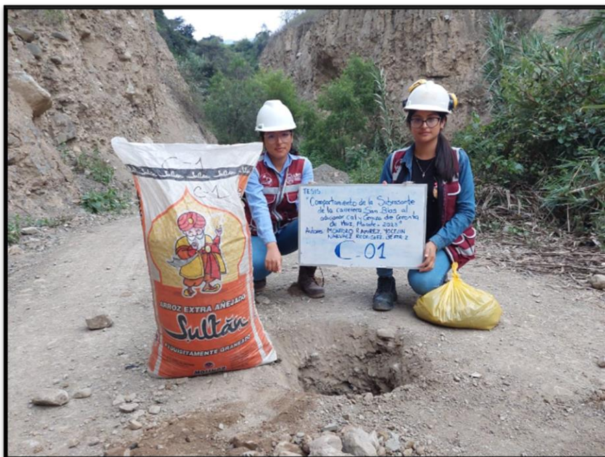
Fotografía 10 Recolección de muestras de la calicata C-01 en la Carretera San Blas- Macate correspondiente al tramo 0+000km – 1+500km
