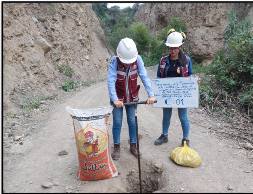
Fotografía 10 Recolección de muestras de la calicata C-01 en la Carretera San Blas- Macate correspondiente al tramo 0+000km – 1+500km
