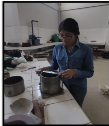
Fotografía 65 Pesaje de los moldes de CBR antes de realizar el ensayo.
