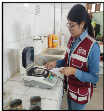
Fotografía 48 Determinación del contenido de humedad de las muestras colocadas en las taras
