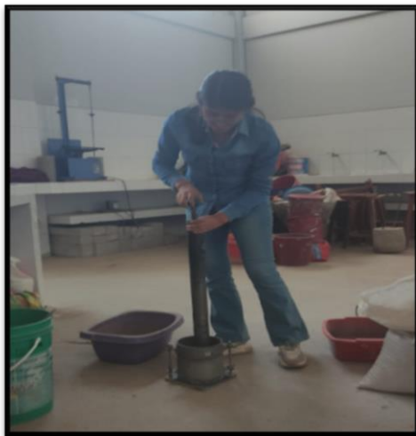
Fotografía 61 Enrasado y pesaje del molde con mezcla de suelo y ceniza de mazorca de maíz con cal.
