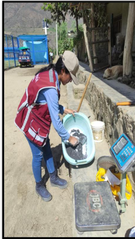
Fotografía 27 Preparación de la mezcla estabilizadora de cenizas de coronta de maíz y cal
