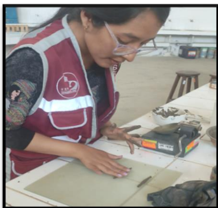
Fotografía 55 Con la muestra del ensayo del límite líquido se procede a tomar muestras para la determinación del límite plástico e índice de Plasticidad.
