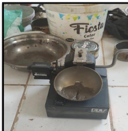
Fotografía 54 Se registró los números de golpes y se extraerá la muestra representativa de cada ensayo, las cuales se procederán a pesar y secar en el horno a 110 \pm 5 °C durante 24 horas, para poder determinar el contenido de humedad.
