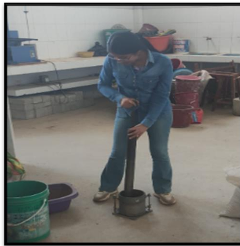
Fotografía 61 Enrasado y pesaje del molde con mezcla de suelo y ceniza de mazorca de maíz con cal.
