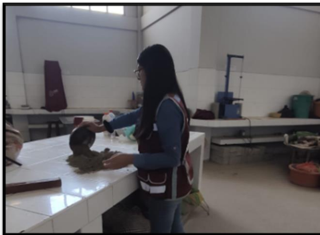
Fotografía 46 Obtención de muestra representativa de cada calicata mediante el cuarteo (MTC E 105).
