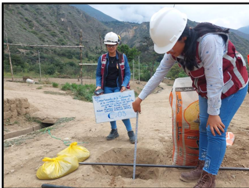
Fotografía 16 Excavación de la calicata C-03 en la Carretera San Blas- Macate correspondiente al tramo 0+000km – 1+500km
