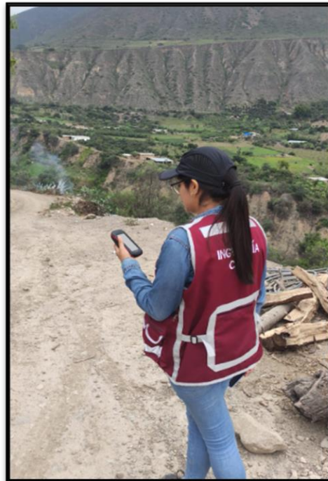
Fotografía 2 Toma de coordenadas con GPS en la progresiva 0+000km correspondiente al tramo de estudio de la Carretera San Blas- Macate
