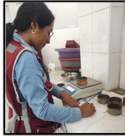
Fotografía 63 Pesaje de las taras y colocación al horno para obtener su peso seco.
