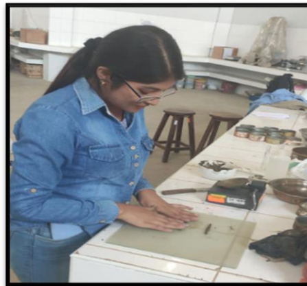
Fotografía 55 Con la muestra del ensayo del límite líquido se procede a tomar muestras para la determinación del límite plástico e índice de Plasticidad.
