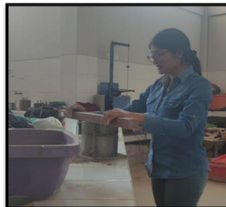
Fotografía 61 Enrasado y pesaje del molde con mezcla de suelo y ceniza de mazorca de maíz con cal.
