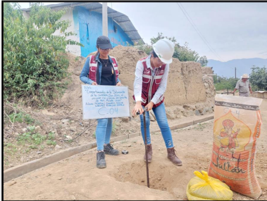
Fotografía 22 Recolección de muestras de la calicata C-04 en la Carretera San Blas- Macate correspondiente al tramo 0+000km – 1+500km
