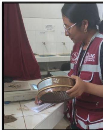
Fotografía 50 Pesaje de las muestras retenidas en cada malla del juego de tamices
