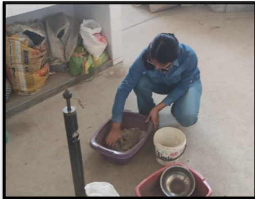
Fotografía 60 Realización del ensayo de Proctor compactando la mezcla del suelo en 3 capas de 25 golpes con pisón manual de caída libre.
