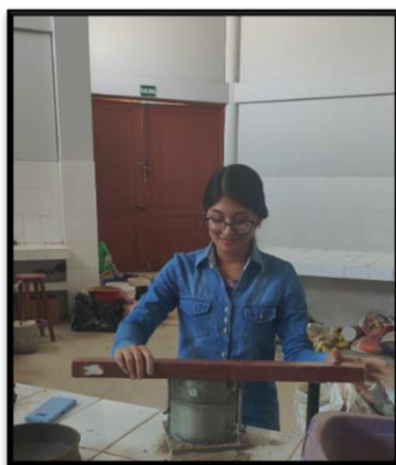
Fotografía 66 Realización del ensayo CBR compactando el suelo en capas
