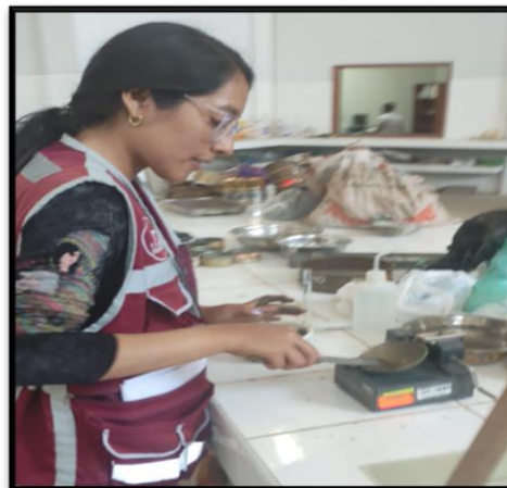
Fotografía 53 Determinación del límite líquido de las respectivas muestras de la zona en estudio con las combinaciones de ceniza de mazorca de maíz y cal
