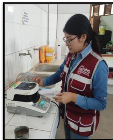
Fotografía 48 Determinación del contenido de humedad de las muestras colocadas en las taras
