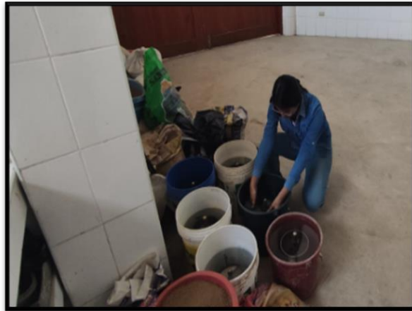
Fotografía 67 Muestras CBR sumergidas en el agua por un periodo de 96 horas, luego de realizado la compactación.
