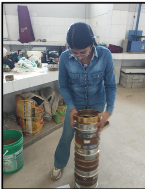
Fotografía 49 Determinación de la granulometría del suelo mediante tamices para ello se realiza el vertido de las muestras de suelo por el juego de tamices para cada calicata.
