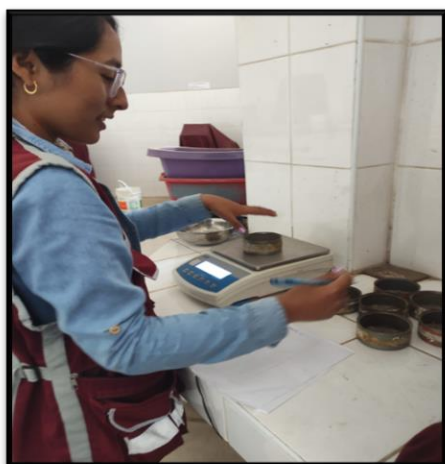
Fotografía 55 Con la muestra del ensayo del límite líquido se procede a tomar muestras para la determinación del límite plástico e índice de Plasticidad.
