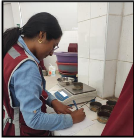
Fotografía 63 Pesaje de las taras y colocación al horno para obtener su peso seco.
