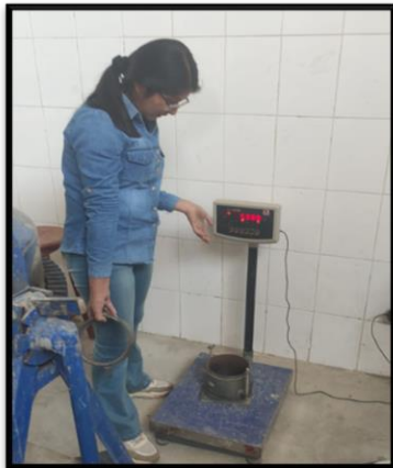
Fotografía 66 Realización del ensayo CBR compactando el suelo en capas
