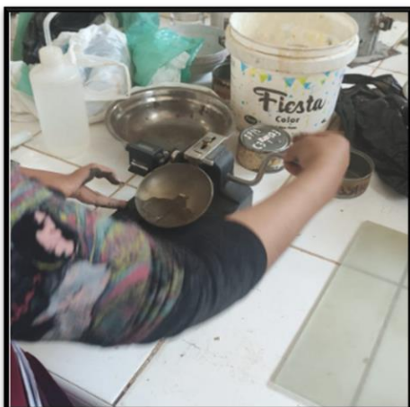
Fotografía 54 Se registró los números de golpes y se extraerá la muestra representativa de cada ensayo, las cuales se procederán a pesar y secar en el horno a 110 \pm 5 °C durante 24 horas, para poder determinar el contenido de humedad.
