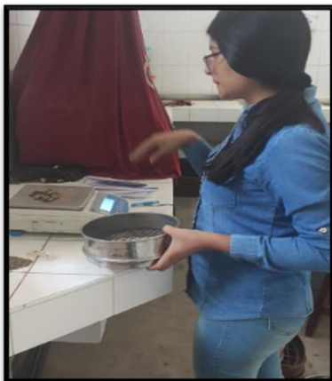
Fotografía 50 Pesaje de las muestras retenidas en cada malla del juego de tamices
