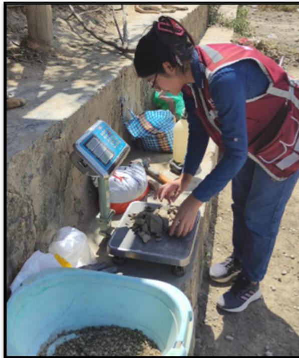
Fotografía 41 Retiramos el cono una vez lleno el agujero con la arena para así determinar su volumen mediante la diferencia de pesos del frasco inicial y final, para determinar la densidad del suelo in situ.
