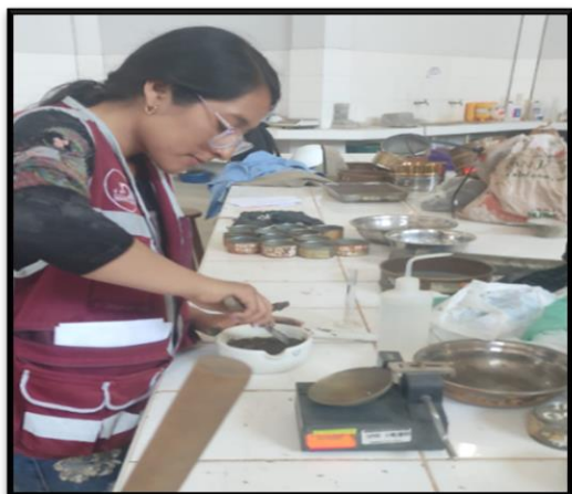
Fotografía 53 Determinación del límite líquido de las respectivas muestras de la zona en estudio con las combinaciones de ceniza de mazorca de maíz y cal
