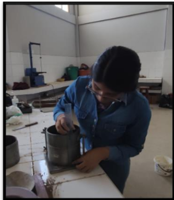
Fotografía 65 Pesaje de los moldes de CBR antes de realizar el ensayo.
