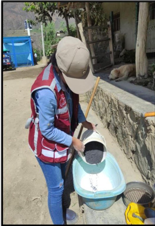
Fotografía 27 Preparación de la mezcla estabilizadora de cenizas de coronta de maíz y cal
