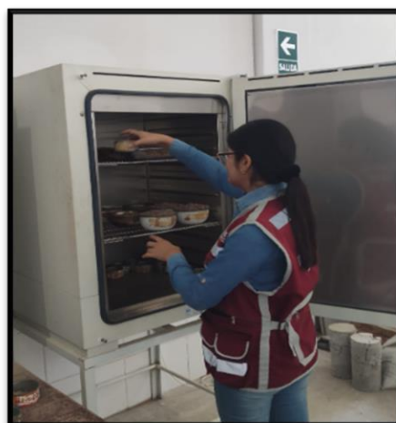
Fotografía 55 Con la muestra del ensayo del límite líquido se procede a tomar muestras para la determinación del límite plástico e índice de Plasticidad.
