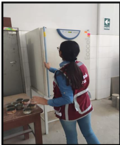
Fotografía 69 Obtención de muestras y colocación al horno para determinar su peso seco.
