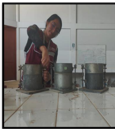
Fotografía 66 Realización del ensayo CBR compactando el suelo en capas
