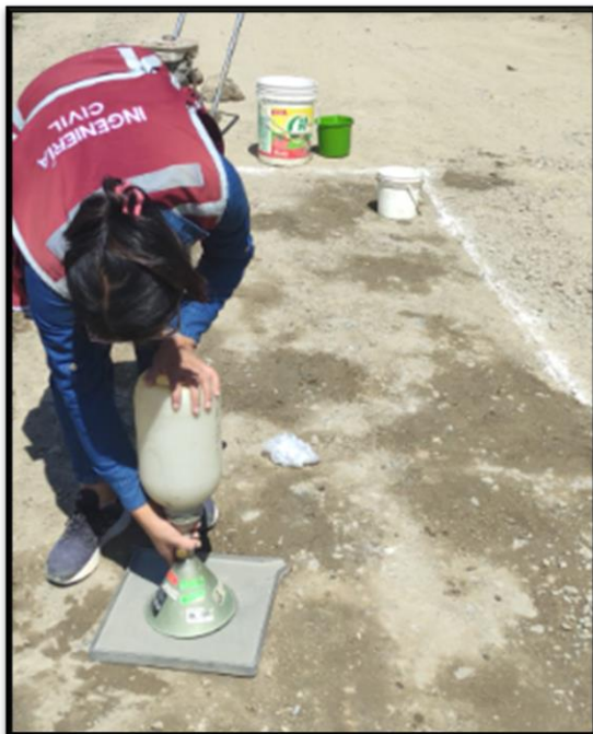
Fotografía 41 Retiramos el cono una vez lleno el agujero con la arena para así determinar su volumen mediante la diferencia de pesos del frasco inicial y final, para determinar la densidad del suelo in situ.
