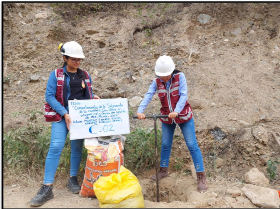
Fotografía 14 Recolección de muestras de la calicata C-02 en la Carretera San Blas- Macate correspondiente al tramo 0+000km – 1+500km
