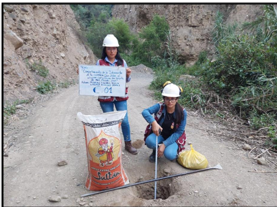
Fotografía 8 Excavación de la calicata C-01 en la Carretera San Blas- Macate correspondiente al tramo 0+000km – 1+500km
