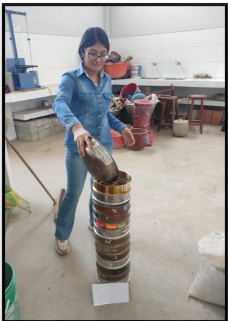
Fotografía 49 Determinación de la granulometría del suelo mediante tamices para ello se realiza el vertido de las muestras de suelo por el juego de tamices para cada calicata.
