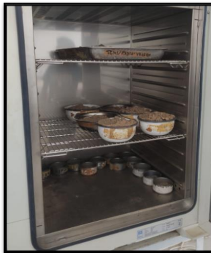
Fotografía 69 Obtención de muestras y colocación al horno para determinar su peso seco.
