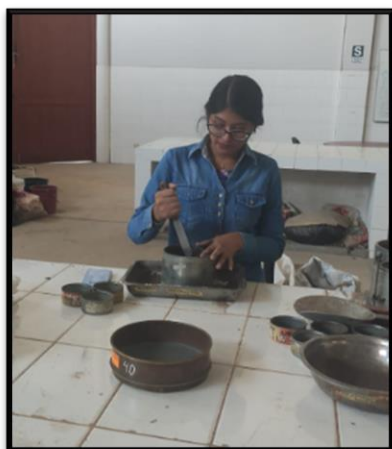
Fotografía 62 Enrasado y Toma de tres muestras de la mezcla compactada para obtener mediante el promedio el óptimo contenido de humedad de cada Proctor.
