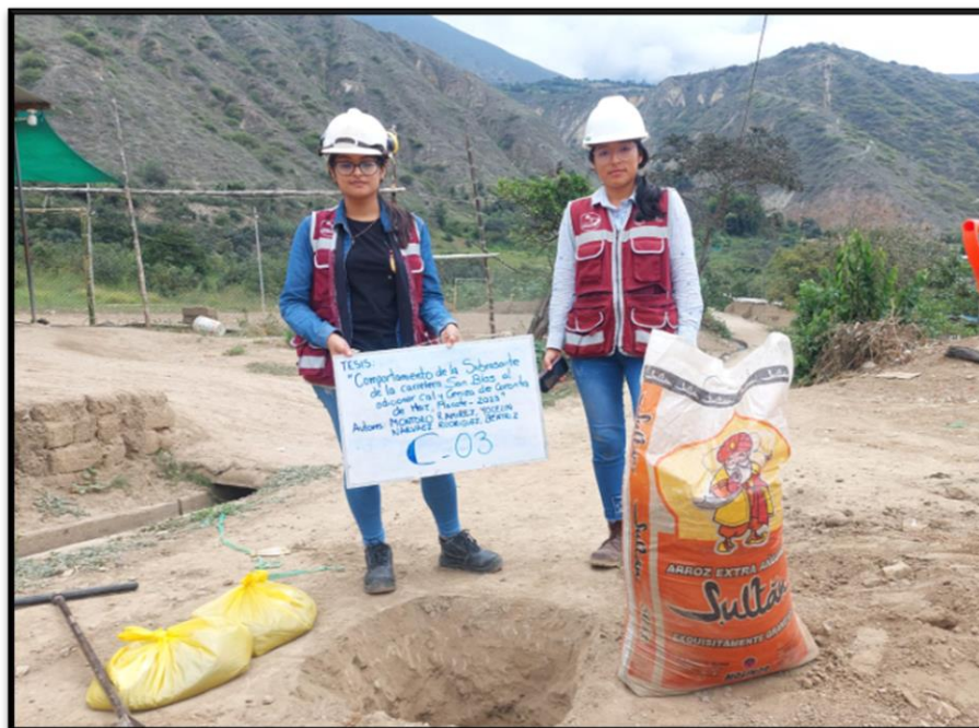
Fotografía 18 Recolección de muestras de la calicata C-03 en la Carretera San Blas- Macate correspondiente al tramo 0+000km – 1+500km
