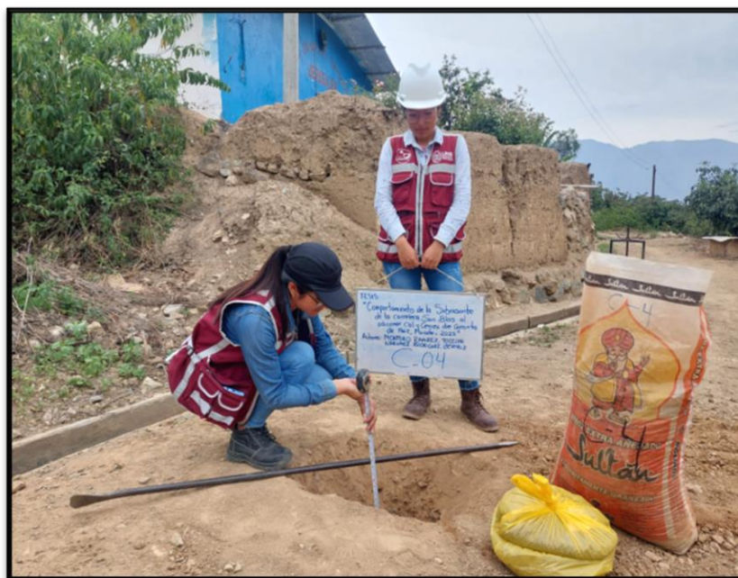
Fotografía 20 Excavación de la calicata C-04 en la Carretera San Blas- Macate correspondiente al tramo 0+000km – 1+500km
