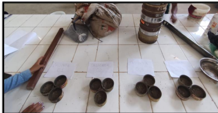
Fotografía 48 Determinación del contenido de humedad de las muestras colocadas en las taras
