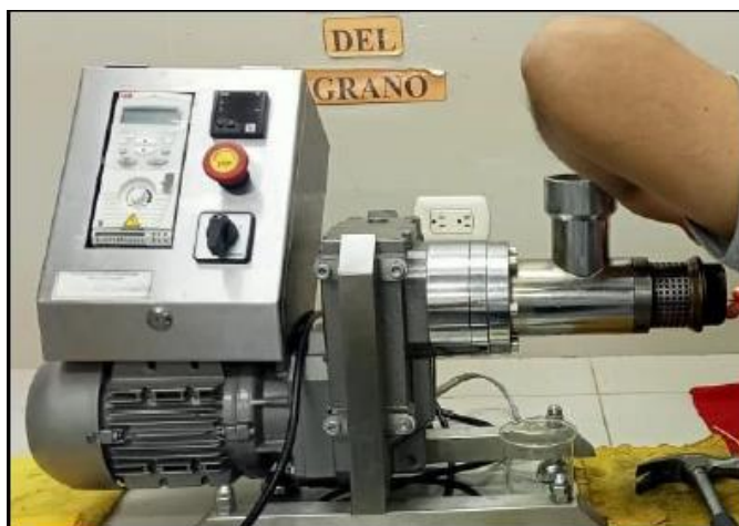
Figura 40: Extracción de aceite por prensado en frío utilizando el Extractor de aceite
