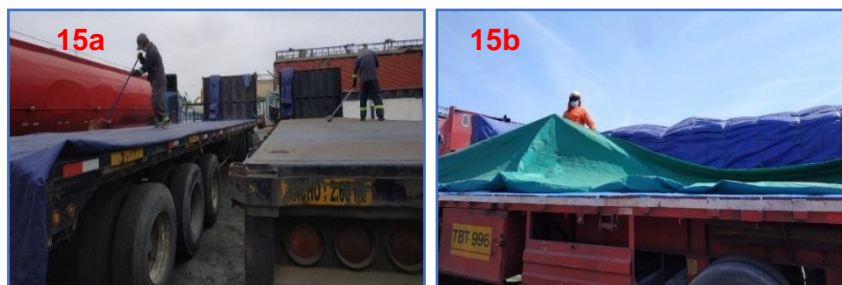
Fig. 15. Inspección de limpieza de plataforma y mantas.
